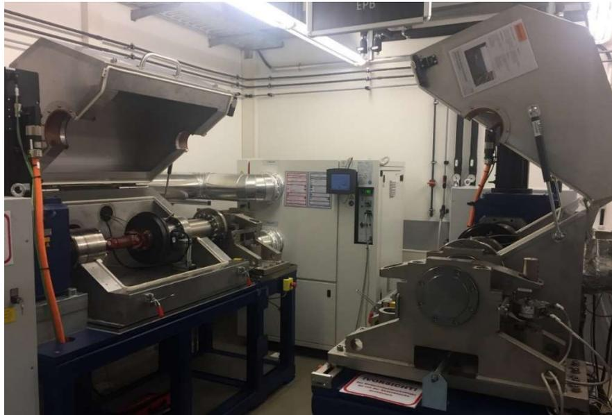
**Figura 20: Torque Flex Test Bench – Intero Sistema**
