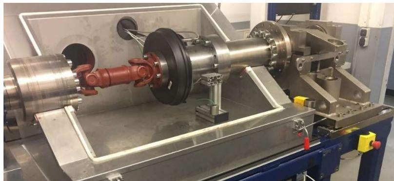
**Figura 21: Torque Flex Test Bench – vista di un solo lato**
