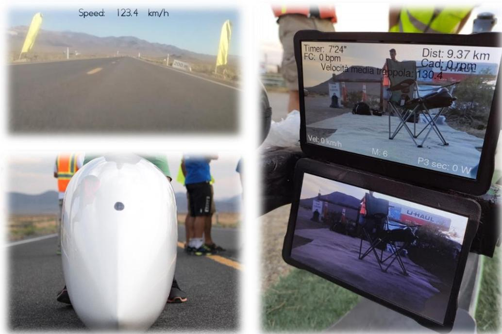
Figura 28: sistema di visione, (alto-sinistra) fotogramma 200 m all'arrivo, (basso-sinistra) carena e plexiglass, (destra) schermi all'arrivo con telemetria.
