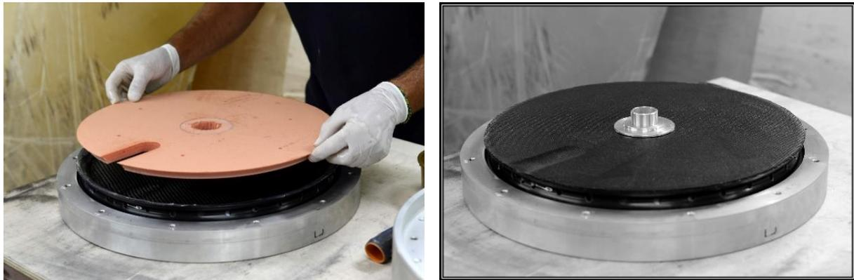
Figura 15: stampo in alluminio per ruota ETRTO 405, schiuma di PVC e tessuti di fibra di carbonio.
