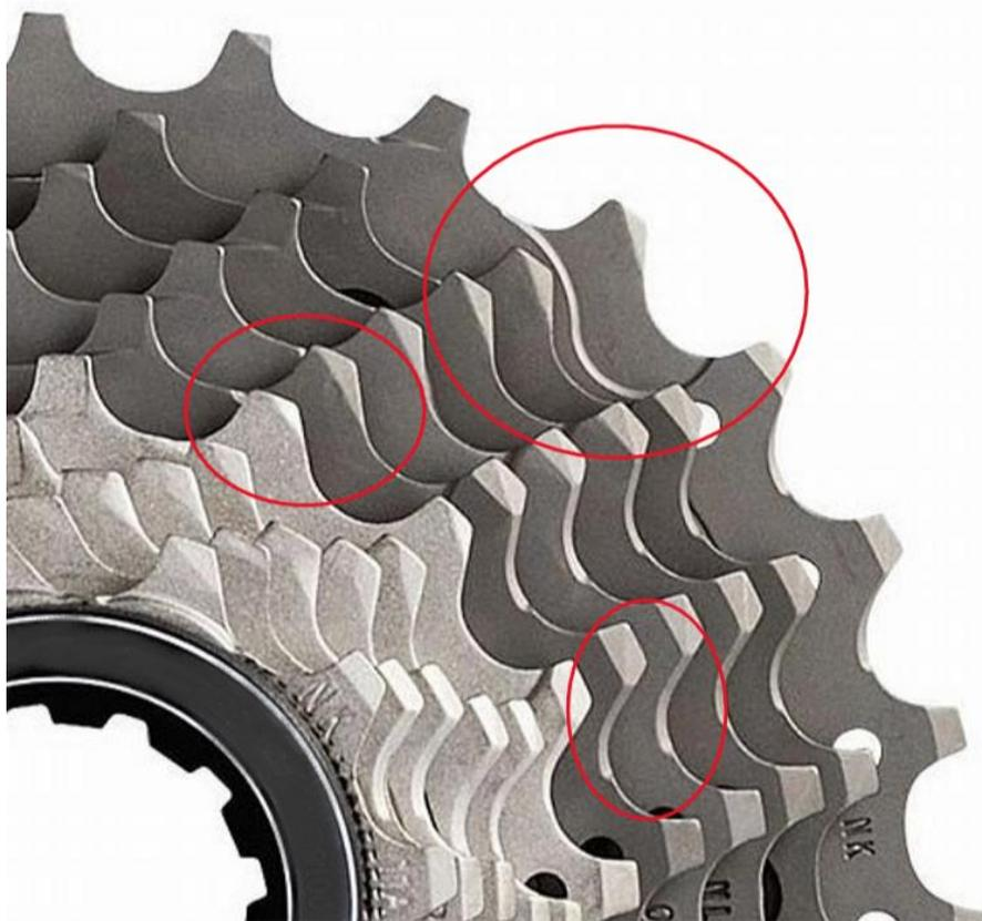
*Figura 22: scanalature per agevolare il cambio marcia.*
