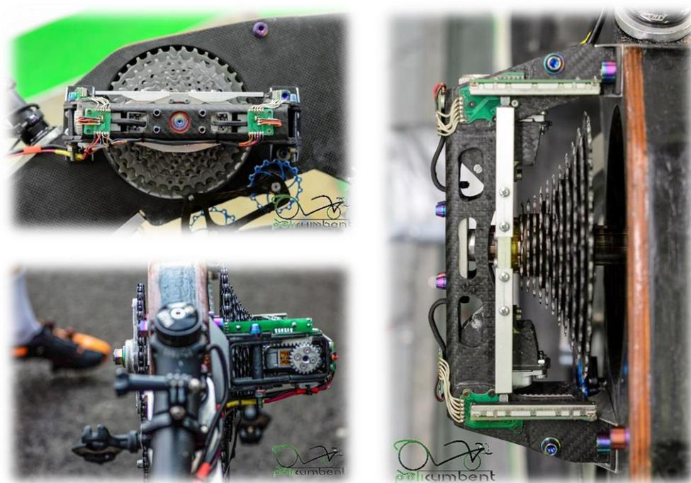
Figura 27: trasmissione a pacco pignoni flottante su prototipo Taurus. Brevettato.
