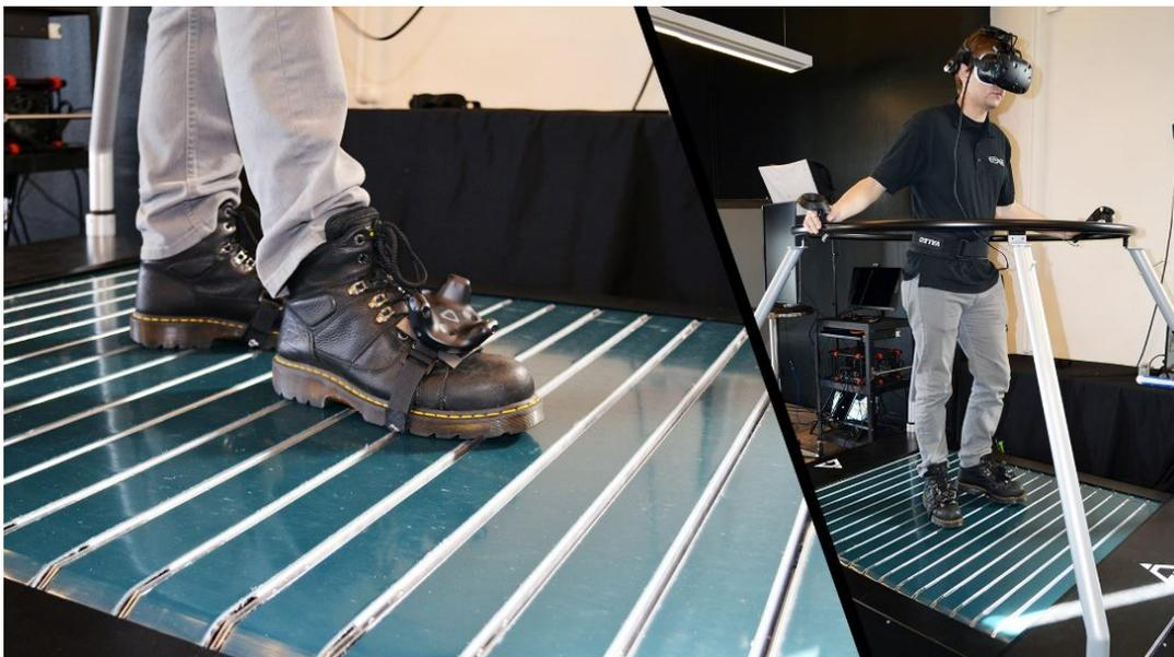
**Figura 3.7:** Infinadeck tapis-roulant e controller
