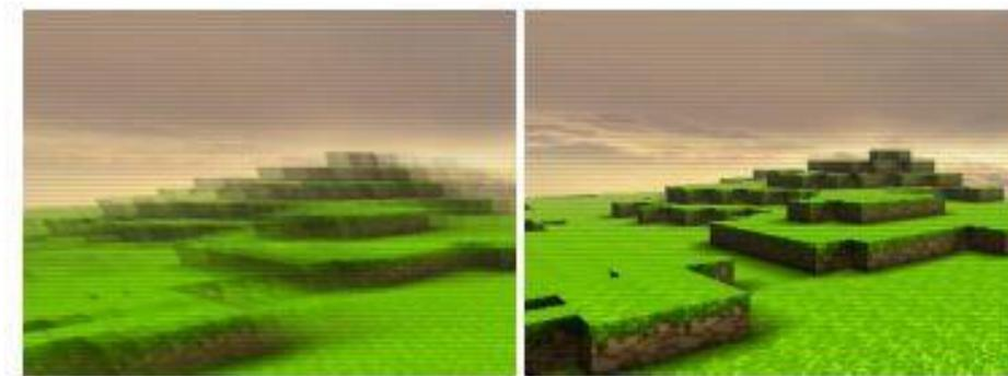
**Figura 3.8:** A sinistra immagine su display ad alta persistenza, a destra stessa immagine su display a bassa persistenza, generati con simulatori *Oculus*
