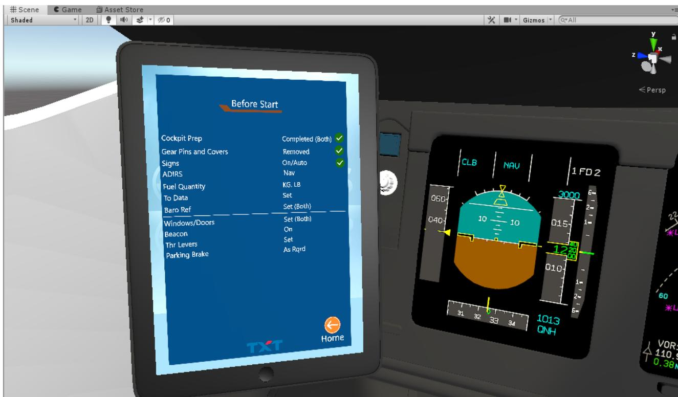
Figura 6.7: Schermata del tablet con gli step della *Before start procedure*
