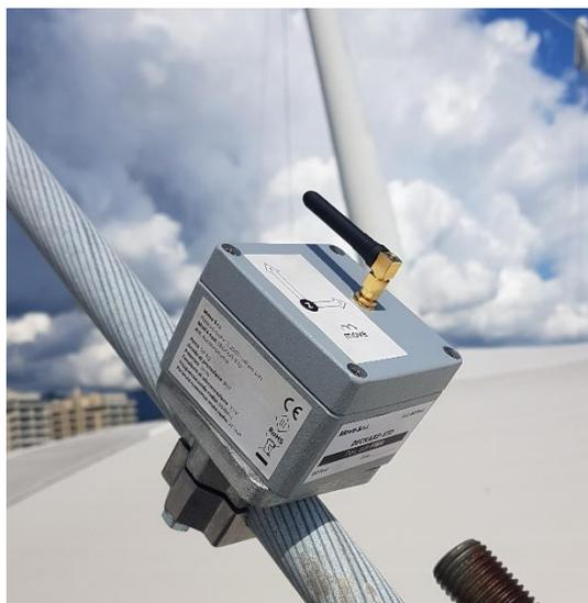
Figura 4: Accelerometro con tecnologia MEMS
