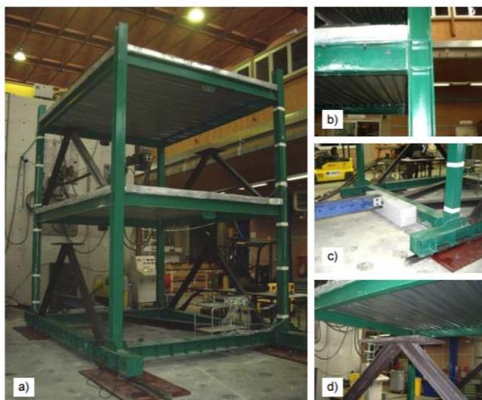
Figura 61: a) Telaio in acciaio analizzato; b)c)d) Particolari strutturali [20]
