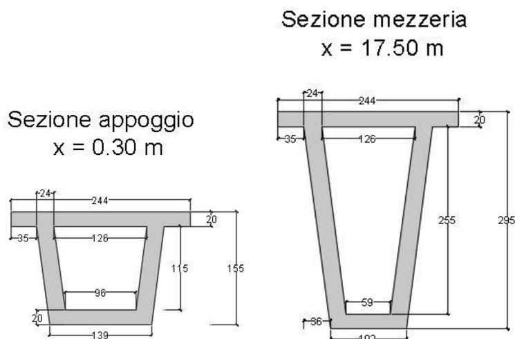
Figura 39: Dimensioni geometriche della sezione trasversale all'appoggio ed in mezzeria
