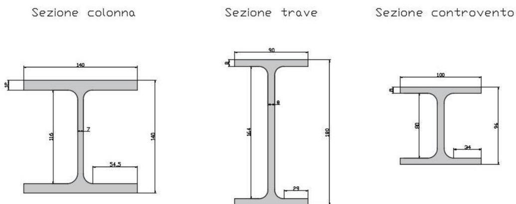
Figura 62: Sezioni trasversali degli elementi del telaio
