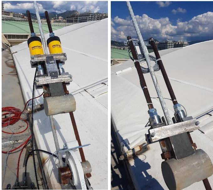
Figura 88: a sx: Trasferimento del carico mediante martinetti cilindrici; a dx: Celle di carico toroidali a fine installazione
