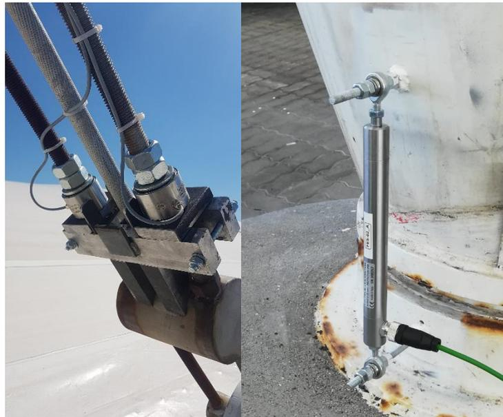
Figura 3: a sx: celle di carico - a dx: fessurimetri
