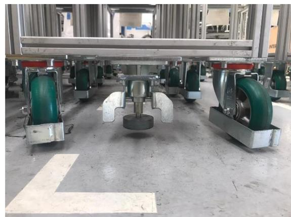
Figura 4.8.2 – Sistema di leva non azionato
