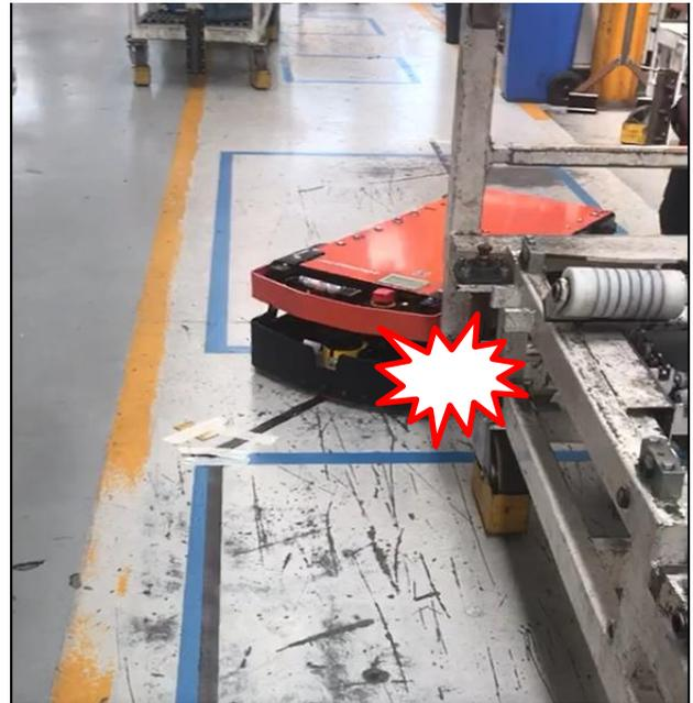
Figura 5.1.1 – Rischio di collisione ad ingresso linea
