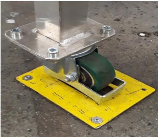
Figura 8.3 – Area destinata al posizionamento della ruota del carrello
