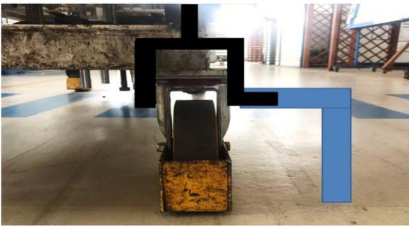
Figura 8.3.1 – Passaggio impedito del carrello
