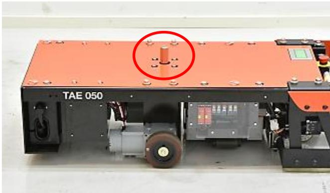
Figura 4.5.3 – Perno elettrico del veicolo
