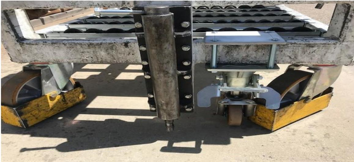
Figura 4.8.3 – Sistema a leva posizionata sulla parte posteriore del carrello
