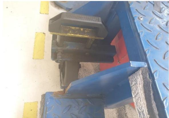
Figura 4.8.4 – Sistema di bloccaggio delle ruote
