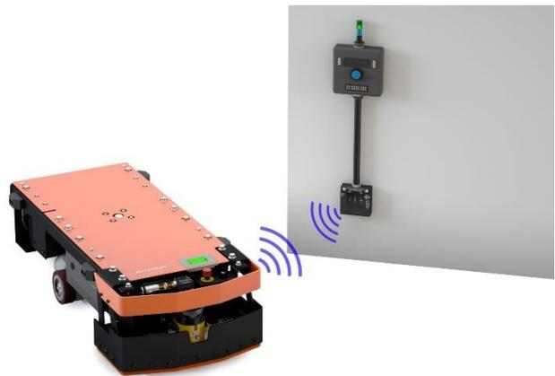
Figura 4.6.3 – Trasmissione del segnale all'AGV
