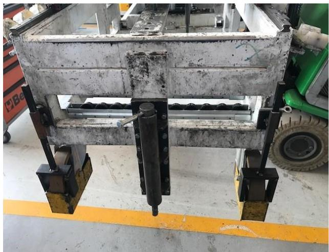
Figura 4.8.6 – Sistema a di bloccaggio a C
