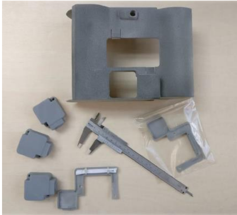
Immagine 5.3 Componenti stampati 3D per protezioni pallet
