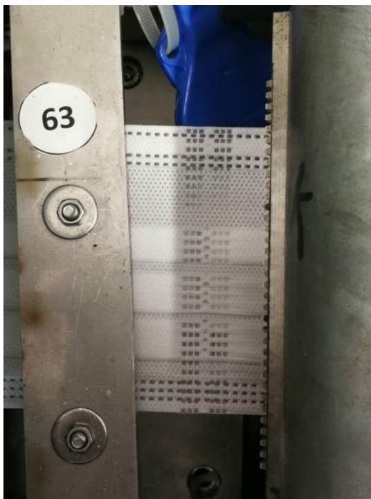
Immagine 3.6 Doppia saldatura laterale su tessuti per mascherine
