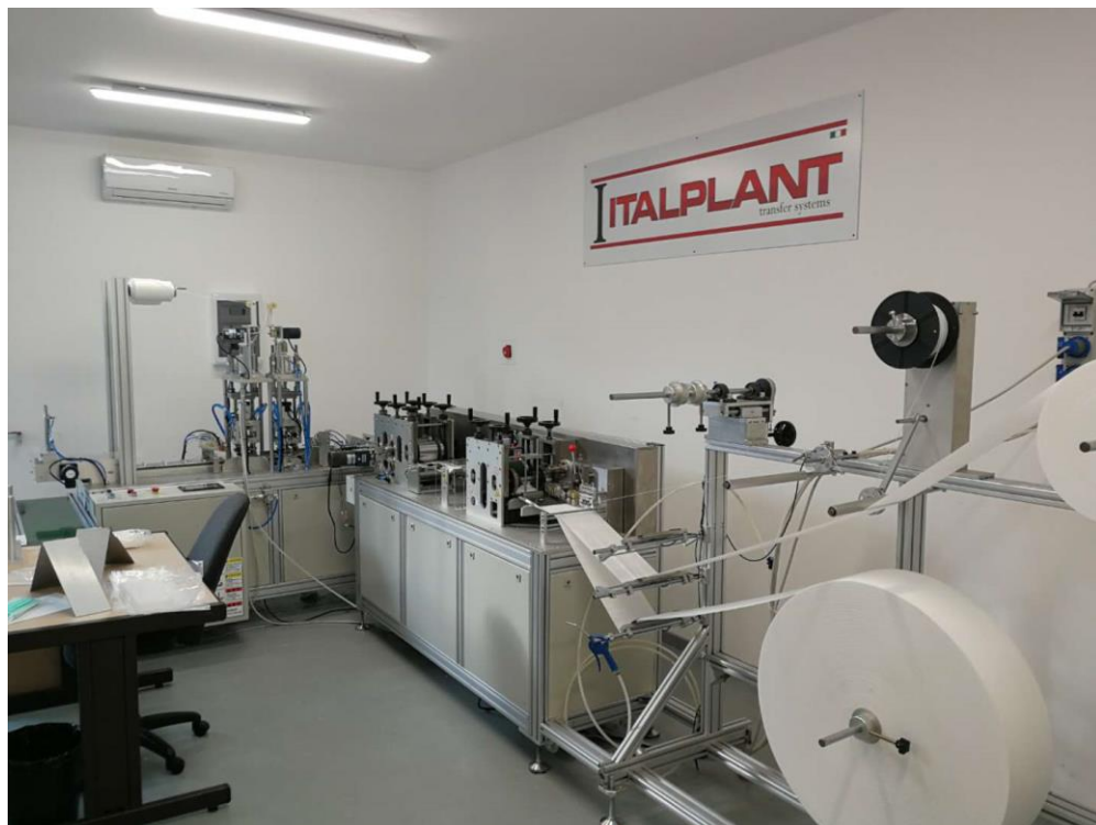
Immagine 3.8 Foto del macchinario per mascherine chirurgiche ridotto presso Italplant
