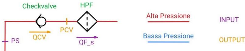
Figura 29: Schema fisico Valvola di non ritorno
