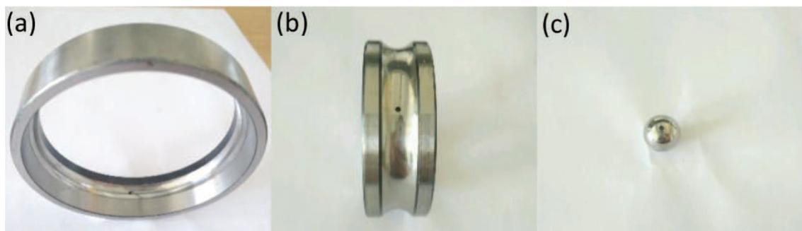
Figura 3.2: Danneggiamenti localizzati simulati artificialmente: (a) pista esterna, (b) pista interna, (c) corpo volvente (sfera) [20].
