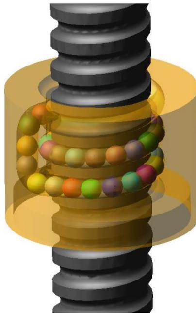
*Figura 3.2 – Modello multibody ADAMS di vite a ricircolo di sfere*
