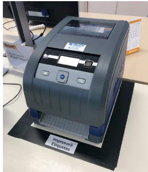
Immagine 17. Stampante di etichette con controllo visivo.
