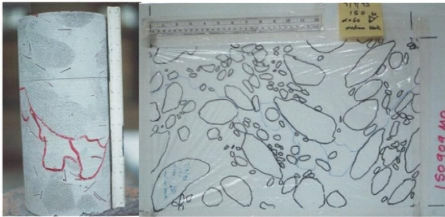
*Figura 17 - Esempio di provino utilizzato durante la sperimentazione la cui superficie di rottura viene riportata su pellicola trasparente (Kalender et al., 2014).*
