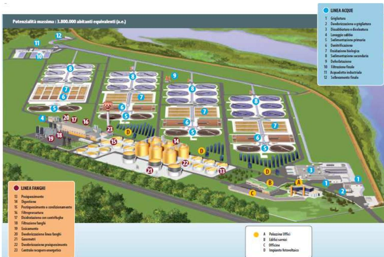
Figura 12: Schema dell'impianto centralizzato di depurazione SMAT
