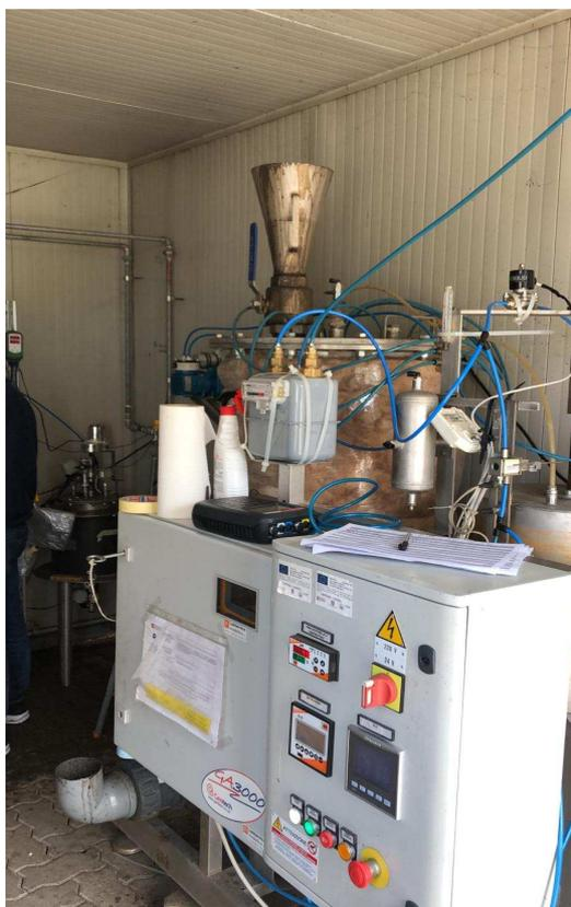
Figura 29: Digestore pilota CSTR da 300 litri
