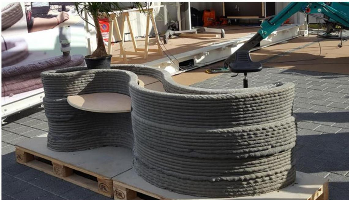
*Figura 41: calcestruzzo a presa rapida per costruzione 3D*
