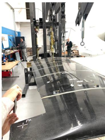
Figura 33: Rimozione elementi di caricamento
