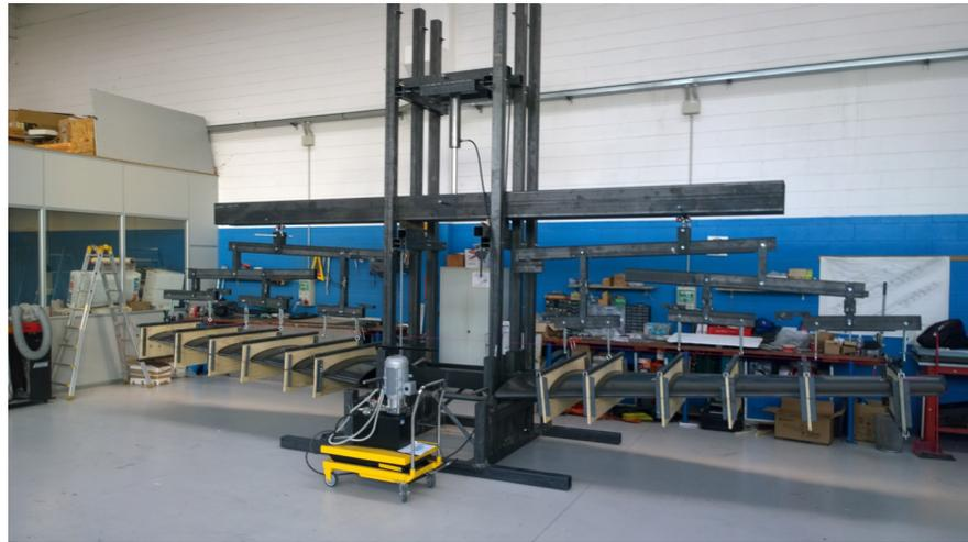
Figura 32: Configurazione sperimentale utilizzata per l'analisi statica dell'ala
