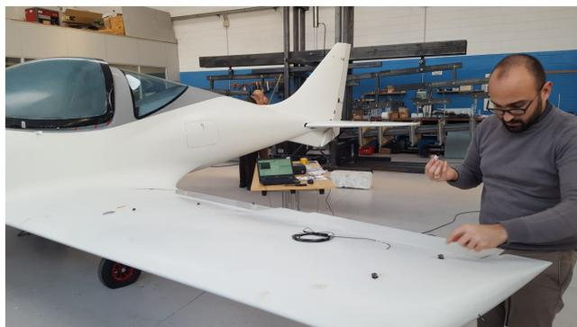
Figura 39: Esecuzione dell'hammer test per velivolo completo
