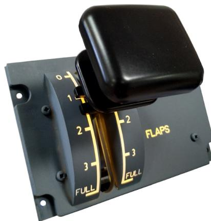
**Figura 56 - Leva per il controllo degli ipersostentatori dell'Airbus A320.**<sup>80</sup>
