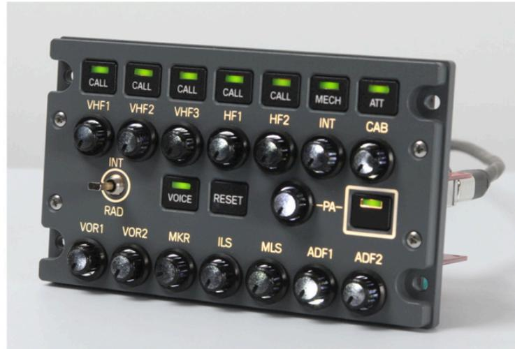
**Figura 53 - Audio Control Panel.<sup>75</sup>**
