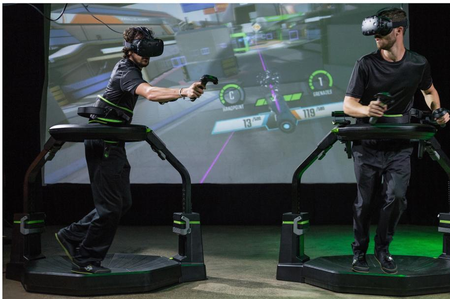
**Figura 19 - Pedana *Virtuix Omni* per muoversi fisicamente convertendo lo spostamento reale in moto nell'ambiente virtuale.<sup>30</sup>**
