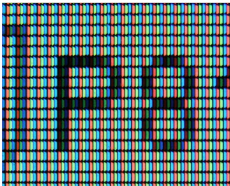
**Figura 20 - Vista ingrandita di uno schermo in cui è possibile osservare i tre *subpixels* costituenti il singolo *pixel* RGB.<sup>31</sup>**
