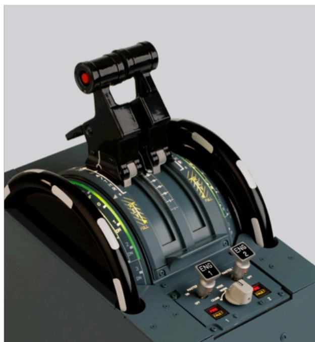
**Figura 57 - Manette dei propulsori, regolatori per il trim di stabilizzatore e pannello di accensione dei propulsori.<sup>81</sup>**
