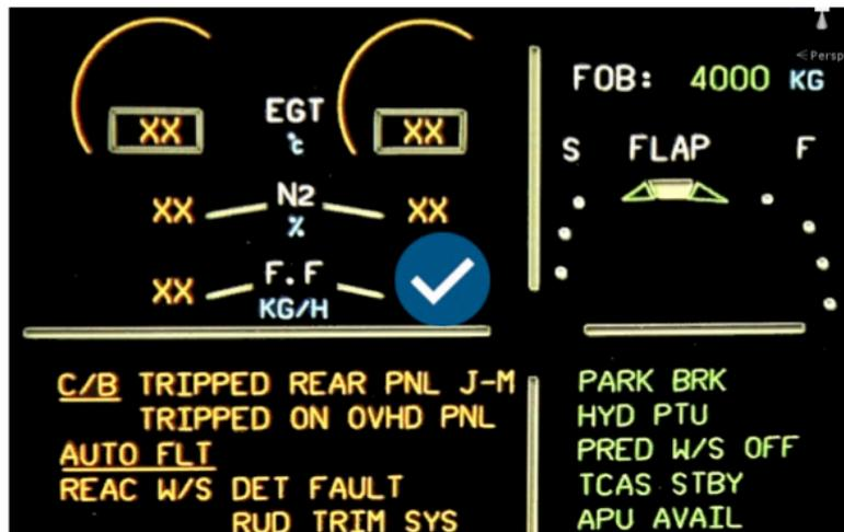
Figura 64 - Esempio di *tick* sul *display* dell'ECAM.<sup>90</sup>
