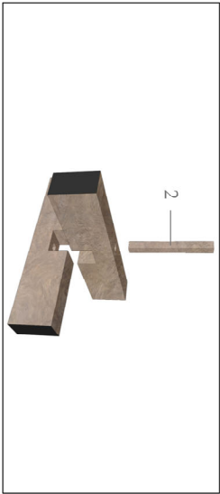
MODELLO CONNESSIONE TENONE-MORTASA ANGOLARE E LINEARE
