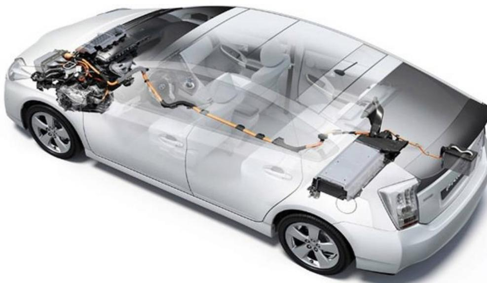
Figura 22: Schema posizionamento del motore elettrico, termico e Batteria al Ni-MH nella Toyota Prius di seconda generazione. Fonte: Toyota
