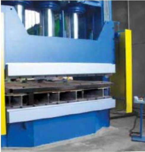
*Figura 30-Pressa per termoformatura*
