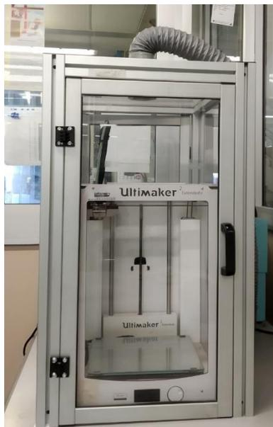
**Figura 5.6: Ultimaker 2 con cappa d'aspirazione**
