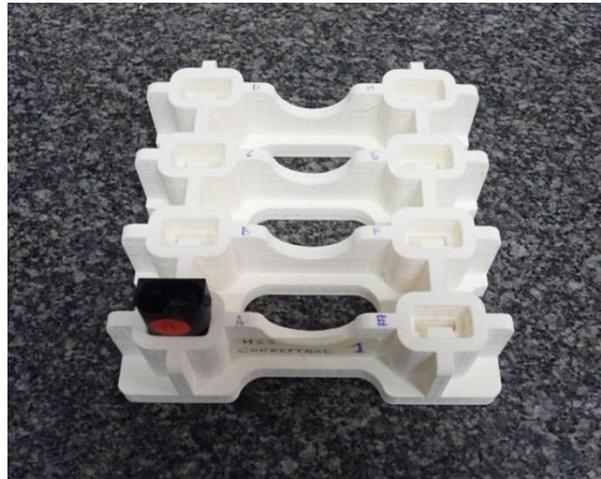
Figura 8.6: portapezzo connettore HSS con un connettore
