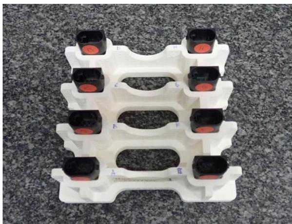
Figura 8.2: portapezzo connettore HSS con 8 connettori
