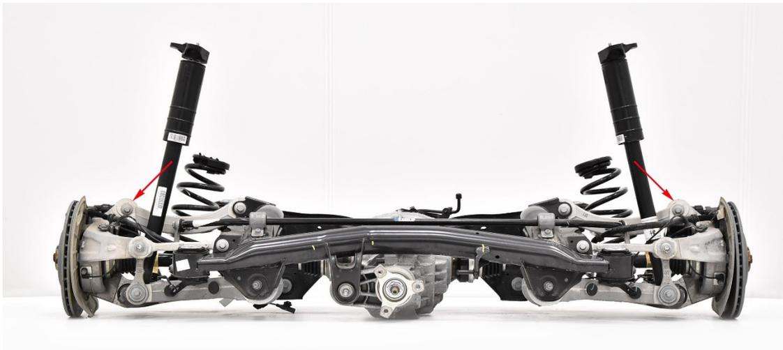
*Figure 6.1 Architettura della sospensione posteriore dell'Alfa Romeo Stelvio*
