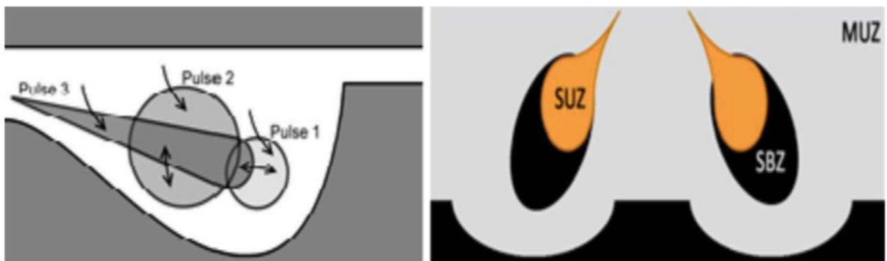
Figura 4.1. - Zone termodinamiche previste dal modello *Di-Pulse*. [13]
