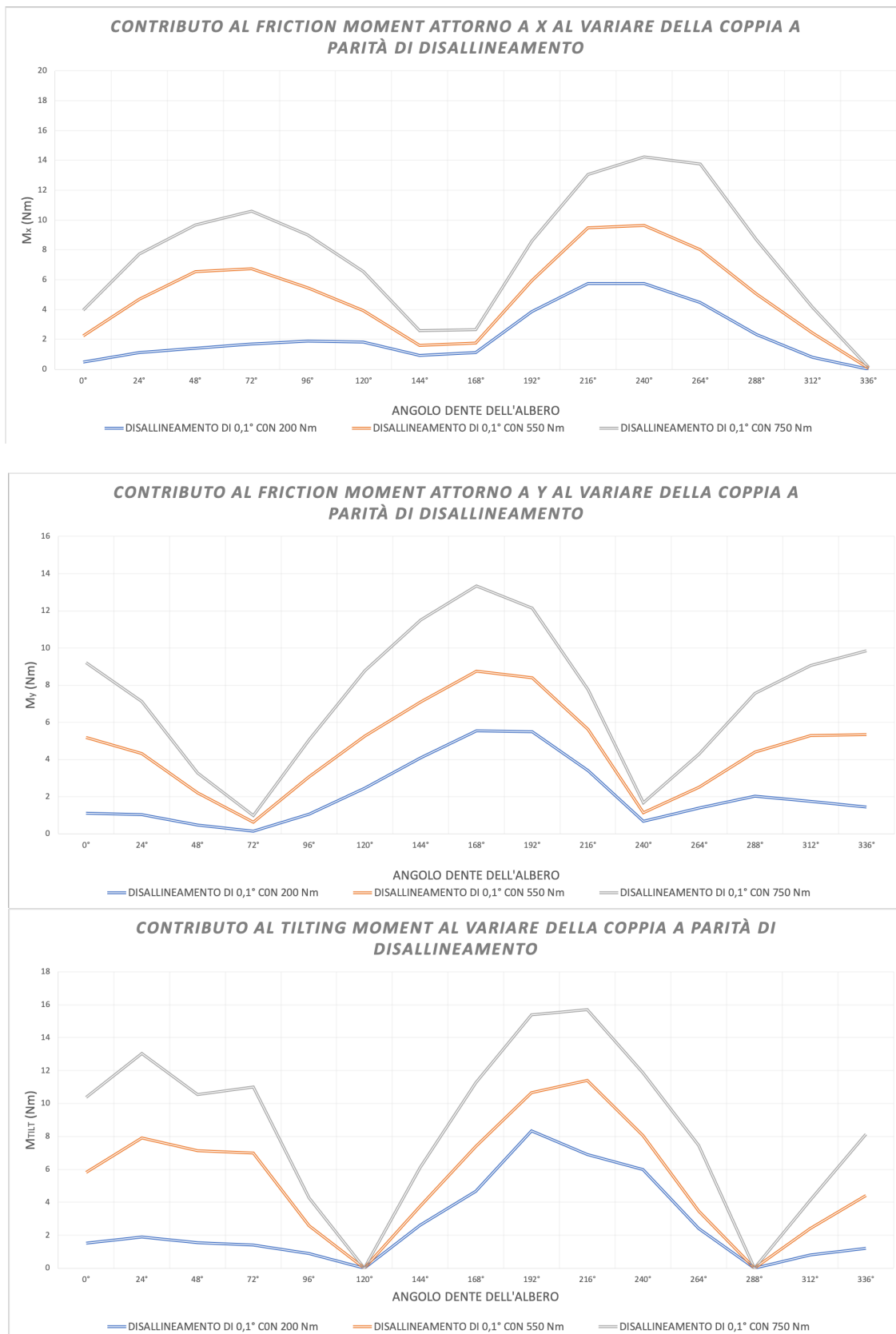
Figura 5.40: Confronto andamenti di a) Tilting e b-c) Friction Moment per ciascun dente
