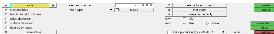
Figura 4.6: Pannello di lavoro “automesh”
