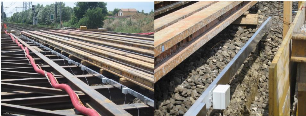
Figura 7.3.7.1 Disposizione dei sensori lungo i binari.
