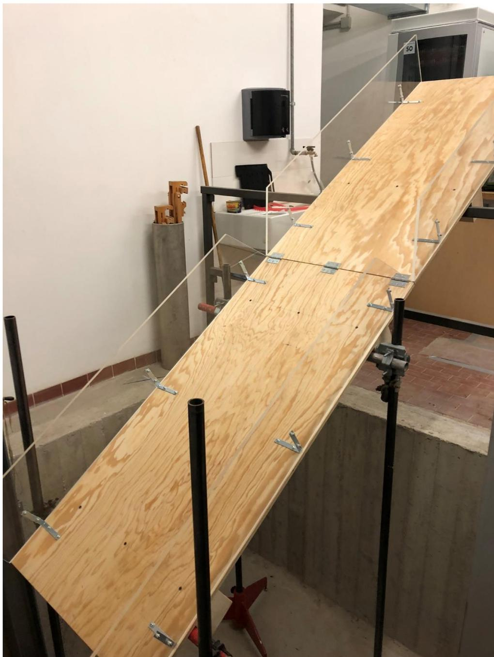
*Figura 52: Canale assemblato e posizionato*
