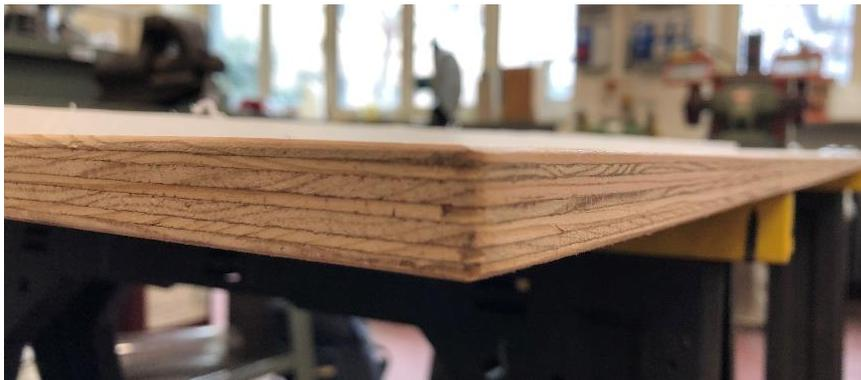
*Figura 41: Struttura a strati del pannello in multistrato fenolico*
