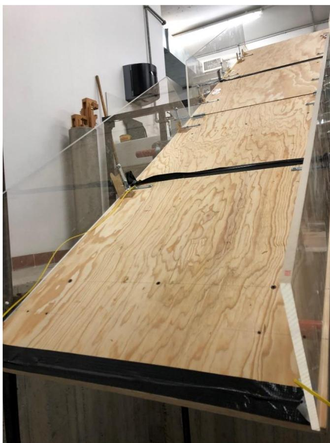
**Figura 54:** Disposizione della fibra fissata in tre sezioni trasversali
