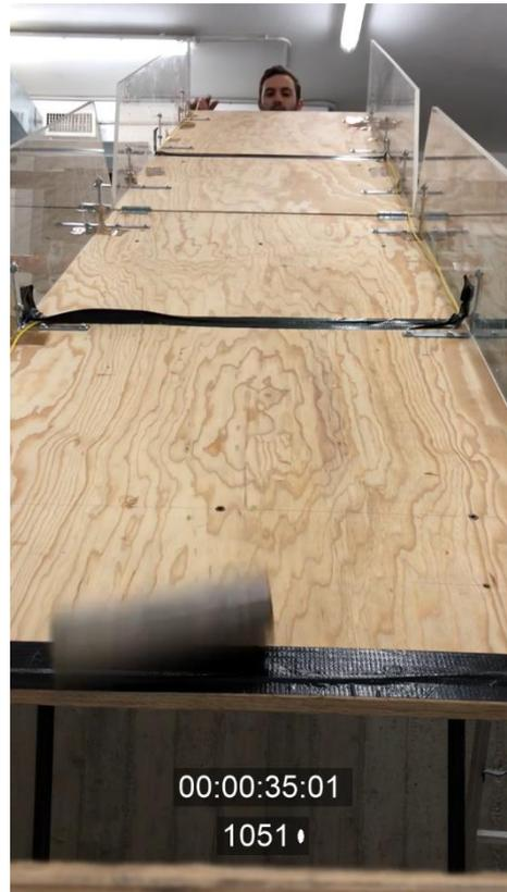
*Figura 77: Fotogrammi rappresentativi della simulazione con timecode e numero del fotogramma in sovrapposizione (provino cavo in metallo)*
