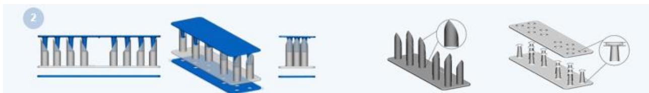
Figura 30: Seconda configurazione processo di accoppiamento con aghi 8G
