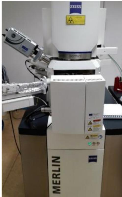
*Figure 31: FESEM ZEISS MERLIN with EDS analyser.*
