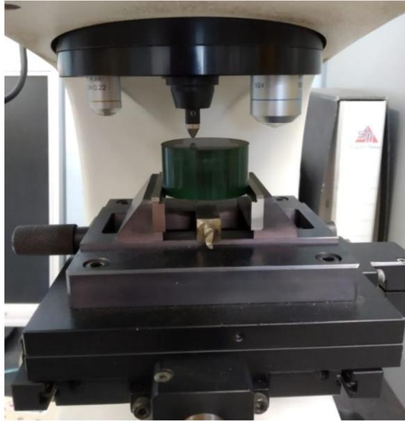
Figura 33: Esecuzione della prova di microdurezza Vickers su un campione
