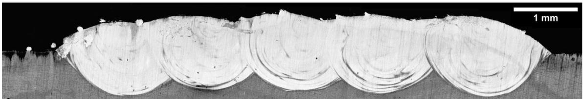
**Figura 62:** Immagine al microscopio ottico con ingrandimento 50x del SL costruito con 75% di potenza laser, 71,4% di velocità di scansione, 1 mm di HD e 69,2% di velocità di rotazione del powder feeder
