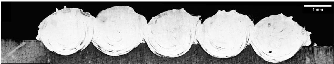
**Figura 61:** Immagine al microscopio ottico con ingrandimento 50x del SL costruito con 75% di potenza laser, 57,1% di velocità di scansione, 1,5 mm di HD e 100% di velocità di rotazione del powder feeder
