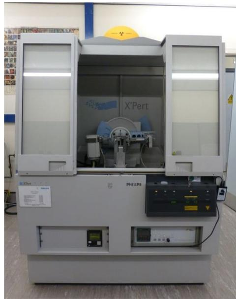
Figura 20: Diffrattometro raggi X X-Pert della Philips
