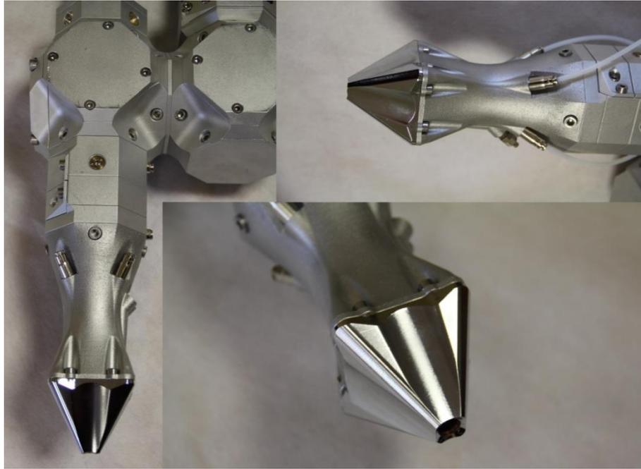
Figura 24: Testa di deposizione sviluppata da Prima Industrie S.p.A. utilizzata per la produzione dei campioni.
