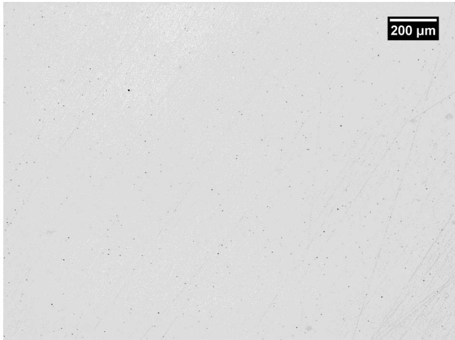
**Figura 65: Immagine a 50x di una parte di sezione del cubo depositato su piastra fredda con i valori di difettosità più bassi**
