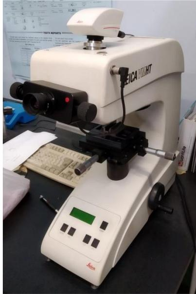
Figura 35: Durometro Vickers VMHT della Leica
