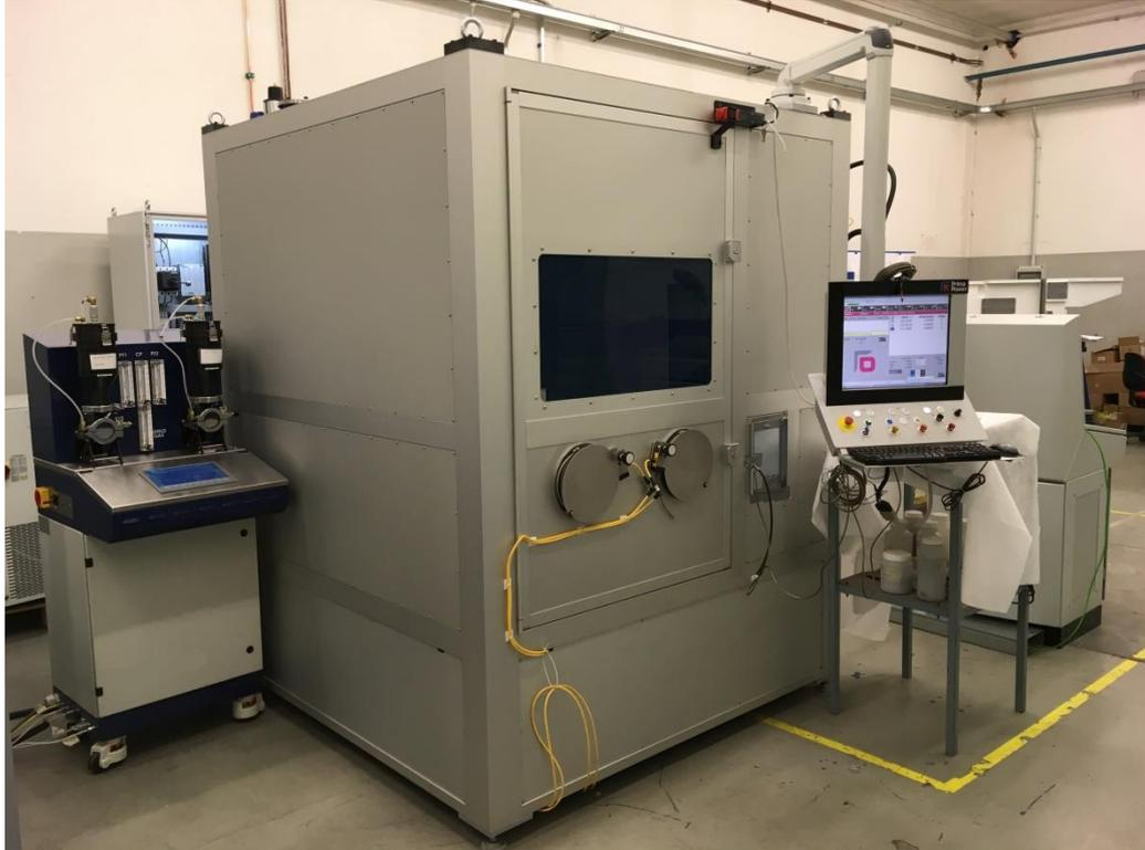
Figura 21: Prototipo DED nel laboratorio presso Prima Industrie S.p.a.
