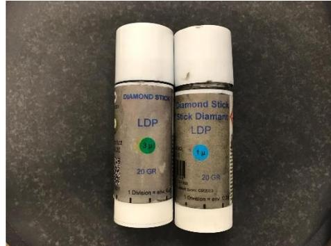
Figure 69) Diamond stick : 1µm and 3µm
