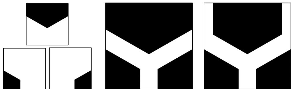
Figura 101: le tre mappe, la risultante della loro moltiplicazione e l'aggiunta delle barre laterali
