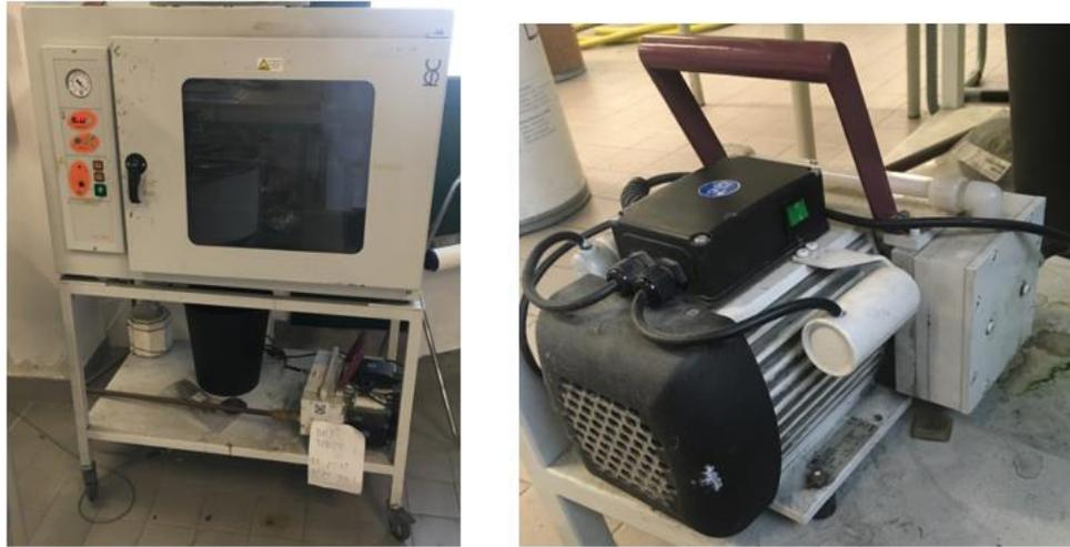
**Figura 23:** Stufa in vuoto utilizzata per effettuare i trattamenti termici dei plastomagneti. A destra si vede un dettaglio della pompa per vuoto.
