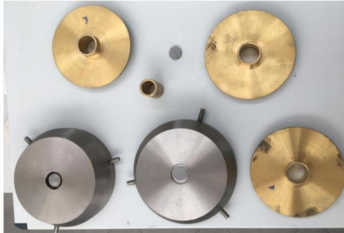
**Figura 67:** Poli dell'isteresigrafo utilizzati per l'analisi delle polveri. In figura si possono vedere anche il cilindro cavo in ottone armonico e i tre piatti distanziatori D3, D2, D1.
