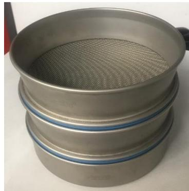
**Figura 39:** Setaccio utilizzato per dividere le polveri e utilizzare quelle con granulometria compresa tra  $45 \mu\text{m}$  e  $1 \text{ mm}$ .
