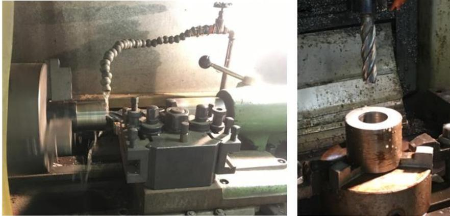
**Figura 88:** A sinistra si può vedere il tornio, mentre a destra la fresa. Entrambi sono stati utilizzati per produrre la custodia esterna del mulino a palette in vuoto.
