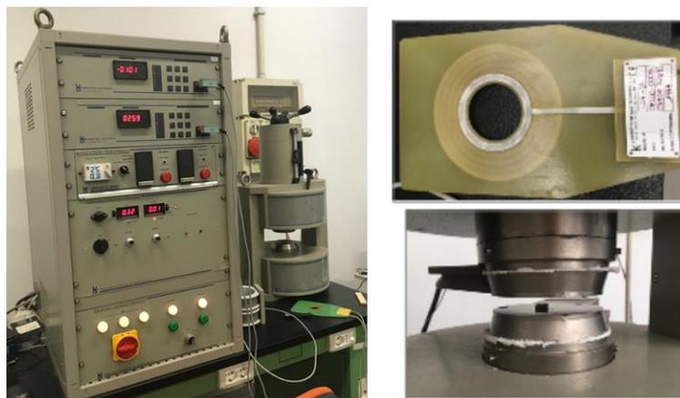
**Figura 29:** Isteresigrafo utilizzato per analizzare i campioni. A destra si vedono un dettaglio della bobina di misura (sopra) e dei poli dell'isteresigrafo (sotto) con all'interno il campione da analizzare.
