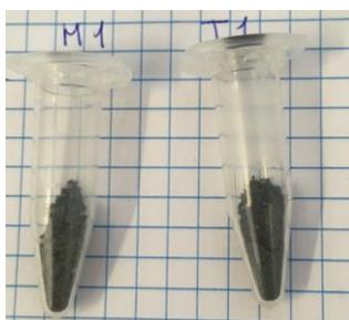
**Figura 82:** Polveri M1 e T1 analizzate con il LECO.
