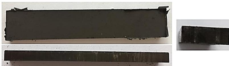
**Figura 33:** Tre differenti viste del plastomagnete CPF RIC 1.8 ES I appena estratto dalla stufa in vuoto.
