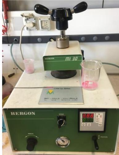
**Figura 74:** Strumento utilizzato per inglobare le polveri nella resina polimerica.
