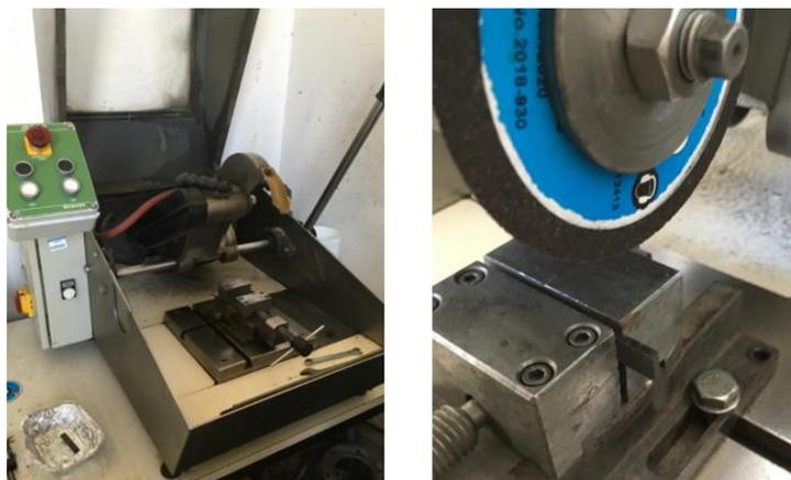
**Figura 25:** Sega a disco utilizzata per sezionare i campioni. A destra si può vedere un dettaglio del disco e del campione.
