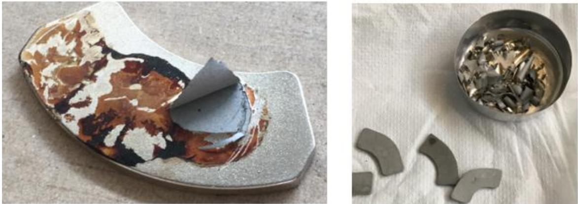
**Figura 38:** Magnete di hard disk da cui si sta rimuovendo lo strato di nichel protettivo. A destra si possono vedere alcuni magneti da cui è stato rimosso lo strato protettivo e un contenitore in cui è stato raccolto il nichel.
