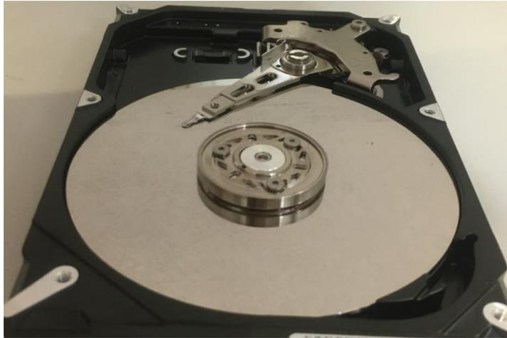
**Figura 5:** Fotografia di un hard disk drive (HDD) da cui è stata rimossa la maschera superiore.
