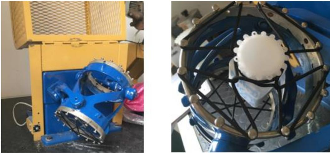
**Figura 21:** Immagini della turbola presente in laboratorio. A sinistra si vede lo strumento e a destra un dettaglio che mostra la modalità di inserimento del campione.
