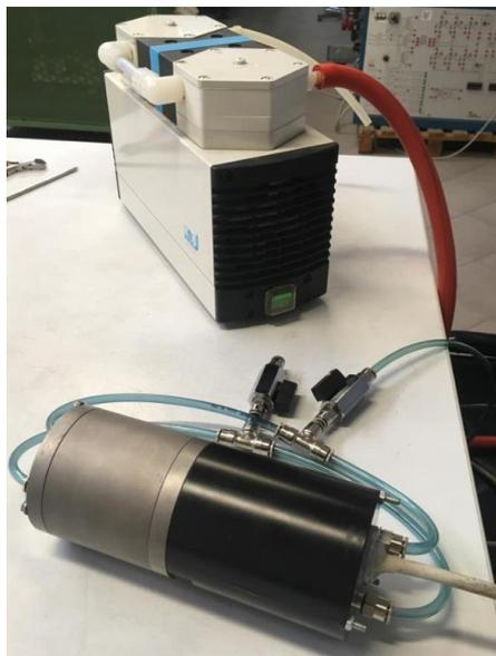
**Figura 89:** Mulino a palette costruito durante il lavoro di tesi chiuso e collegato alla pompa per vuoto.
