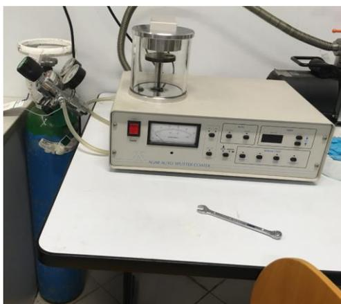
**Figura 77:** Macchinario utilizzato per lo sputtering di oro sui campioni che dovranno essere analizzati al SEM. Sulla sinistra è visibile anche la bombola di argon che sparge l'oro sulla superficie.
