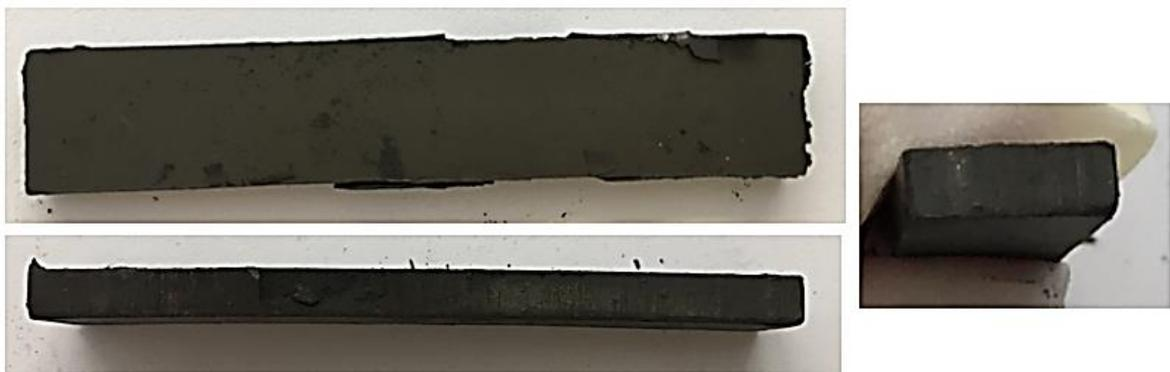
**Figura 24:** Tre differenti viste del plastomagnete CPLV RIC 1.8 I appena estratto dalla stufa in vuoto.
