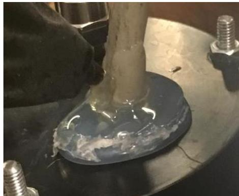
**Figura 100:** Fissaggio del cavo di alimentazione del motore mediante colla a caldo alla parte inferiore del mulino a palette in vuoto.
