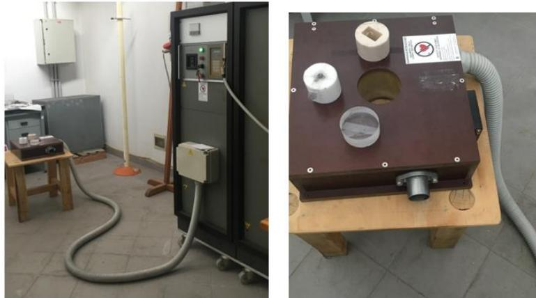
**Figura 28:** Magnetizzatore utilizzato per magnetizzare i campioni. A destra si vede un dettaglio della bobina del magnetizzatore.
