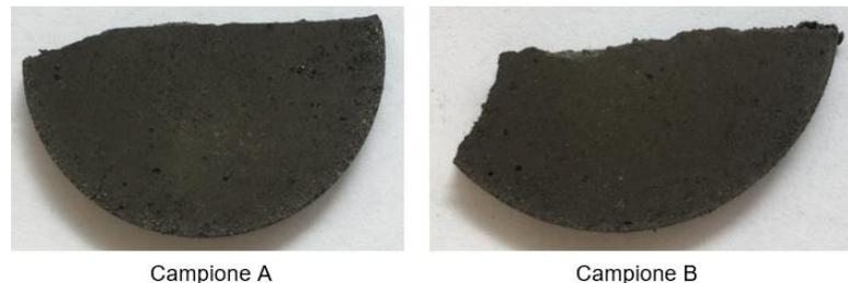
**Figura 54:** Campioni ottenuti spezzando a metà il plastomagnete CPF RIC 1.8 ES II. Il campione A subirà un trattamento termico in aria, mentre il campione B in vuoto.
