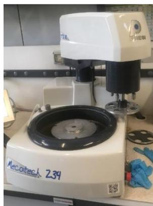
**Figura 75:** Lucidatrice utilizzata per lucidare le polveri inglobate nella resina polimerica.
