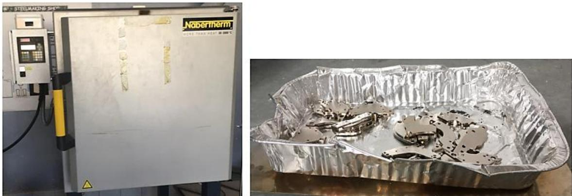
**Figura 37:** Forno in aria utilizzato per smagnetizzare i magneti. A destra si vede il contenitore con all'interno i magneti appena estratti dal forno, con ancora attaccato il  $\mu$ -metal.
