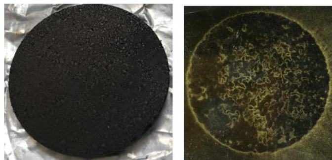
**Figura 40:** Plastomagnete CPLV RIC 1.8 II dopo che è stato estratto dalla stufa in vuoto. A destra si può vedere una foto del medesimo campione analizzato con la carta verde.
