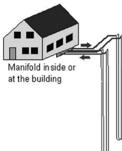
Figura 18 - Sistema geotermico a circuito chiuso - sonde geotermiche verticali ([www.geo-energy.org](http://www.geo-energy.org))
