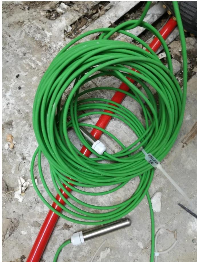
*Figura 37 – Sensore di temperatura immergibile*
