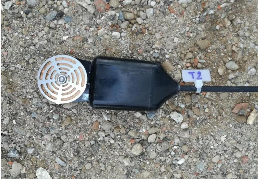
Figura 43 - Misuratore di potenziale idrico TEROS 21
