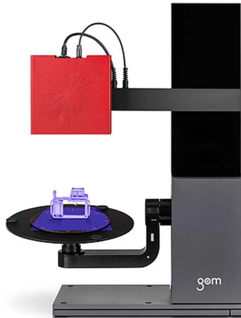
Figura 6: esempio di impiego della tavola rotante nel sistema GOM: ATOS ScanPort
