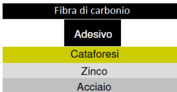
Figura 1.7 Materiali coinvolti nell'incollaggio del tetto in fibra di carbonio con adesivo bicomponente a base poliuretana.
