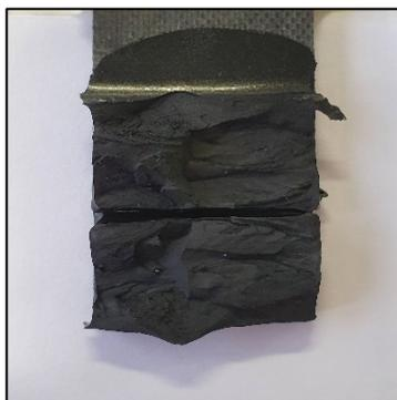
Figura 3.59 Esempio di distacco adesivo del Betaforce™ 2850S che ha polimerizzato 24h con provino carteggiato.
