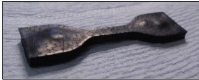
Figura 3.28 Provino Simson ISR 70-08 AP che ha reticolato per 168h, invecchiato 24h in liquido lavavetri NLA/FF e successivamente sottoposto ai tre cicli termici.
