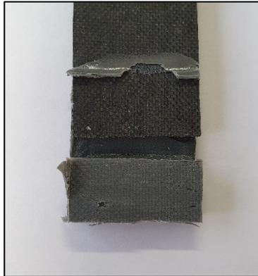
Figura 3.44 Esempio di distacco adesivo del Betaforce™ 9050S che ha polimerizzato 24h.
