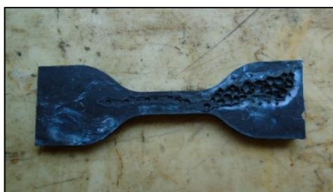
Figura 3.31 Esempio di aspetto dei provino di Simson ISR 70-08 AP riscontrato dopo i cicli termici.
