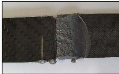
*Figura 3.39 Esempio di distacco coesivo dell'adesivo Betaforce™ 9050S che ha polimerizzato 1h.*
