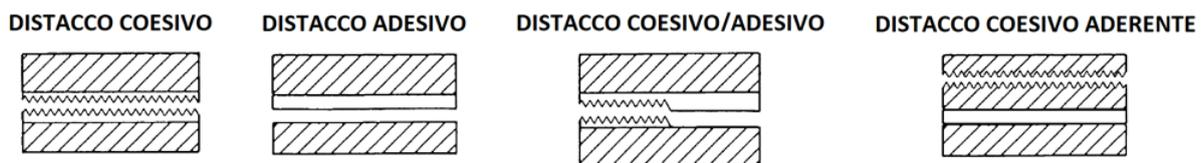
Figura 1.4 Meccanismi di distacco del giunto.
