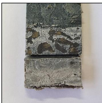
Figura 3.51 Esempio di distacco adesivo del Betaforce™ 9050S che ha polimerizzato 24h con provino carteggiato.
