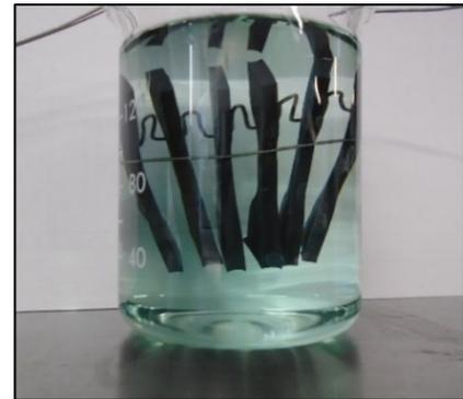
Figura 2.10 Immersioni dei provini a doppia T nel liquido lavavetri NLA/FF.
