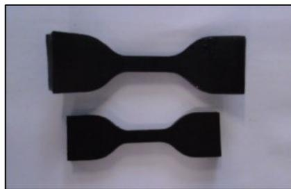
Figura 3.27 Provino di Simson ISR 70-08 AP prima dell'immersione in basso e dopo 24h di immersione nel liquido NLA/FF in alto.
