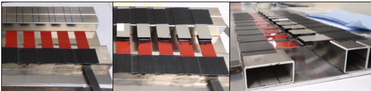
Figura 2.6 Preparazione del provino con giunto a sovrapposizione.
