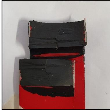
Figura 3.18 Distacco coesivo dell'adesivo Sikaflex®-250 IF-10.
