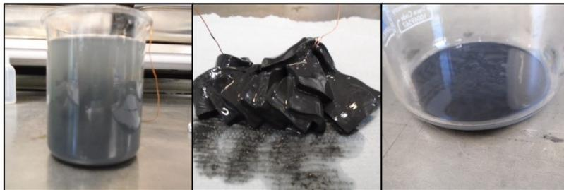
Figura 3.24 Provini di adesivo Simson ISR 70-08 AP dopo immersione di 24h nel liquido lavavetri NLA/FF
