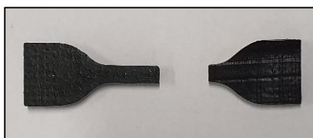
Figura 3.6 Esempio di rottura del provino a doppia T di adesivo Sikaflex<sup>®</sup>-250 IF-10.
