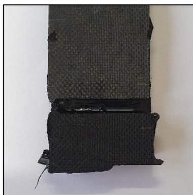
Figura 3.55 Esempio di distacco adesivo del Betaforce™ 2850S che ha polimerizzato 24h.
