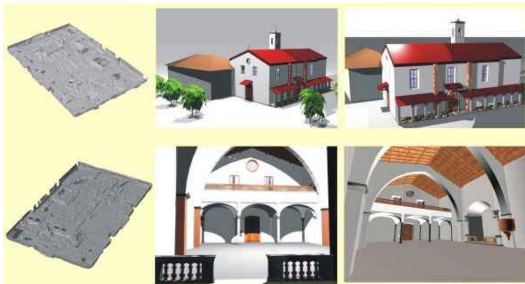
Rappresentazione 3D degli scavi derivante dall'interazione dei dati ottenuti dall'impiego del laser scanner; Rendering raffiguranti l'esterno e l'interno della Chiesa
