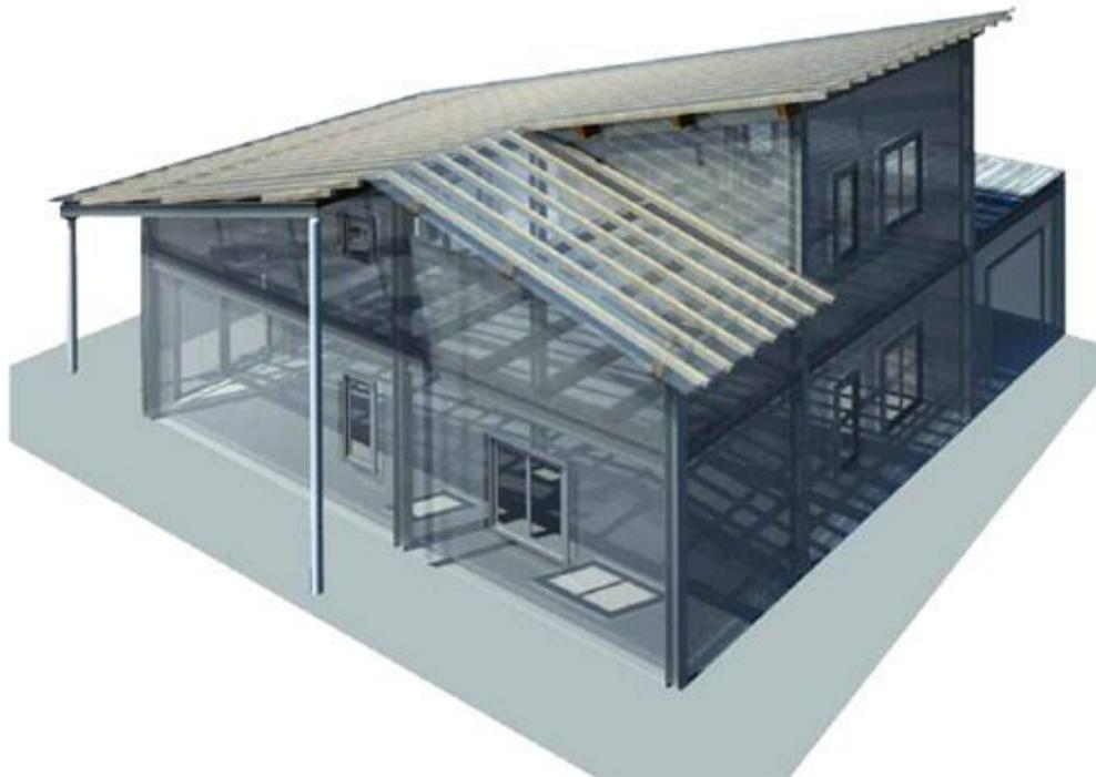
Fig. 21 - Rappresentazione grafica di un edificio costruito a secco. Fonte: promozioneacciaio.it
