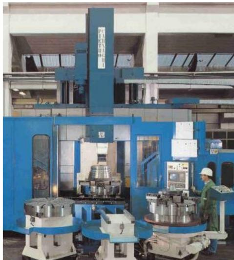
Figura 15. Centro di lavorazione ad asse verticale.
