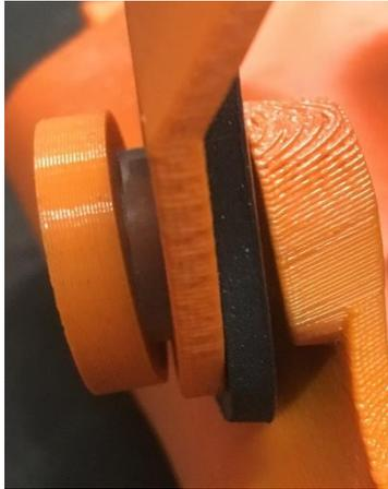
L'ultima configurazione studiata ha previsto l'inclusione di un singolo distanziale sul perno ispessito di 7 mm in diametro: così i giochi in direzione medio-laterale e nelle direzioni antero-posteriore e longitudinale sono stati decrementati rispettivamente di 3 mm e di 10 mm.
