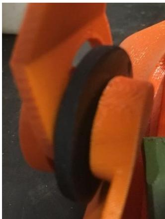
La seconda prova di flessione ha previsto l'inserimento di un distanziale sul perno di ogni giunto. Esso è stato realizzato in gomma rigida, ha uno spessore pari a 3 mm, un diametro interno di 8 mm ed un diametro esterno di 30 mm. La scelta dei diametri è stata fatta sulla base del perno e del foro: in particolare è stato scelto un diametro esterno di 30 mm per evitare il passaggio del distanziale all'interno del foro.
