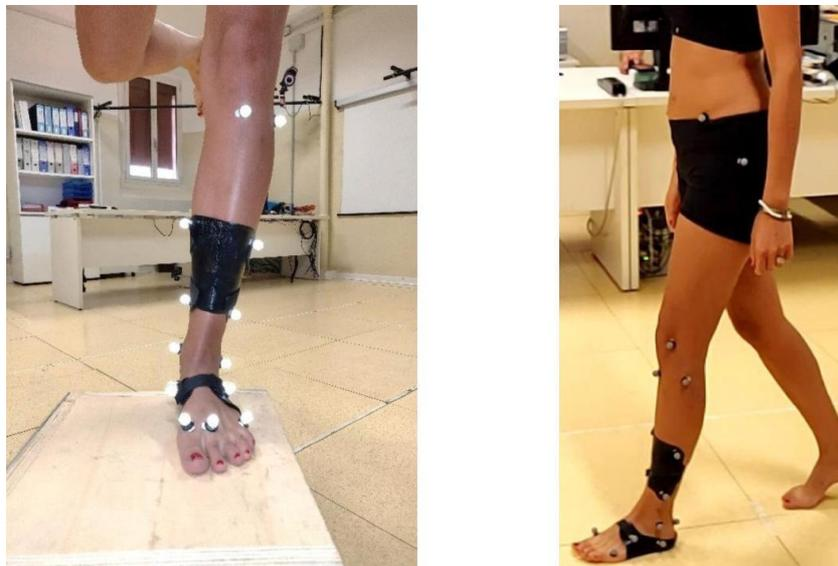
Figura 6.8 Vista frontale e laterale del posizionamento dei marker nelle analisi cinematiche prese in considerazione [19]
