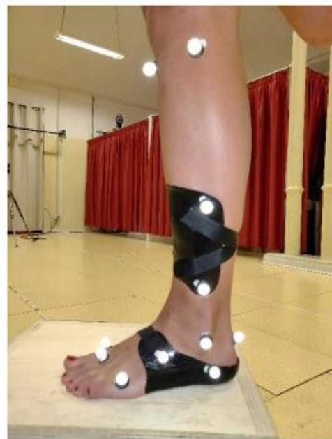
Figura 6.2 Rappresentazione del set di marker tecnici sui due gusci e del set di marker anatomici [19]
