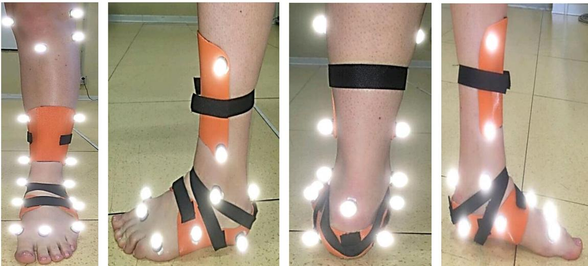
Figura 7.3 A partire da sinistra vista frontale, laterale, posteriore e mediale del posizionamento dei marker tecnici sui gusci di gamba e piede
