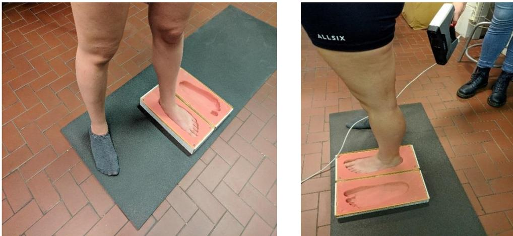
Figura 5.2 Soggetto in condizione di appoggio con piede sinistro posto in una schiuma fenolica (sx), fase di scansione (dx)
