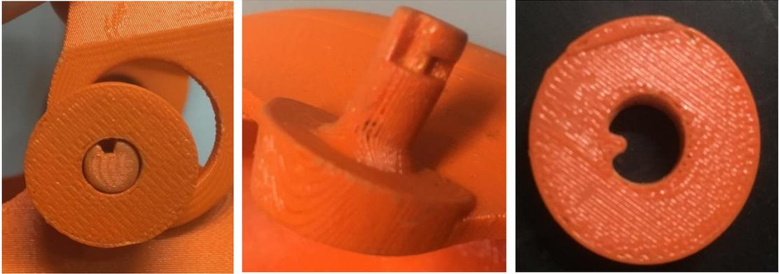
Figura 6.25 Nella figura di sinistra è rappresentato l'accoppiamento perno-foro con il sistema di bloccaggio, al centro è visibile il perno e a destra il tappo con il dente integrato
