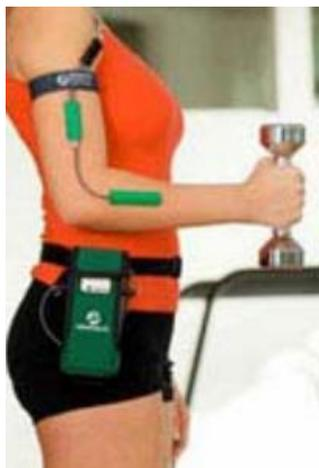
Figura 2.2 Elettrogoniometro per la misura dell'angolo al gomito
