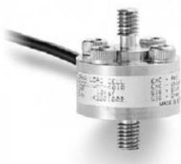
La cella di carico utilizzata è un modello UMM, prodotta dalla Dacell, in grado di misurare forze fino ad un'intensità di 50 Kgf sia in trazione che in compressione. Essa ha forma cilindrica ed è dotata di due alberi filettati utili per il fissaggio e per l'applicazione della forza.
