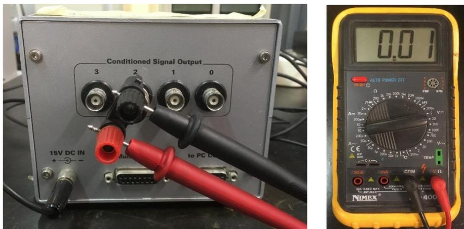
Figura 8.3 Blocco di condizionamento (sx) e multimetro digitale (dx) utilizzati nel sistema di misura
