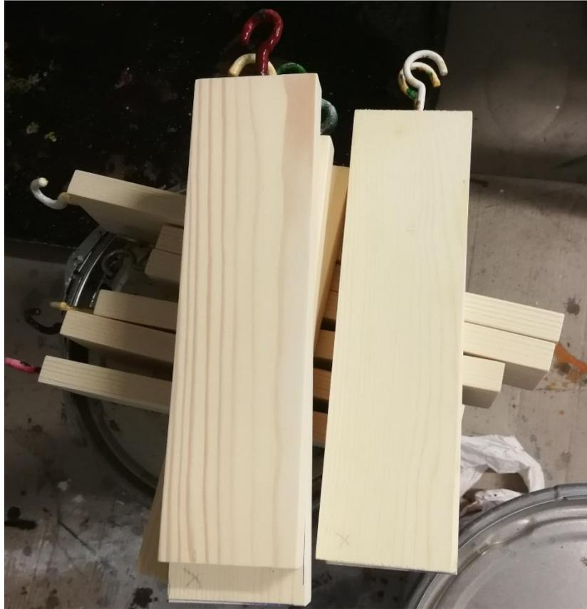
*Figura 17 Provini in legno prima della verniciatura*
