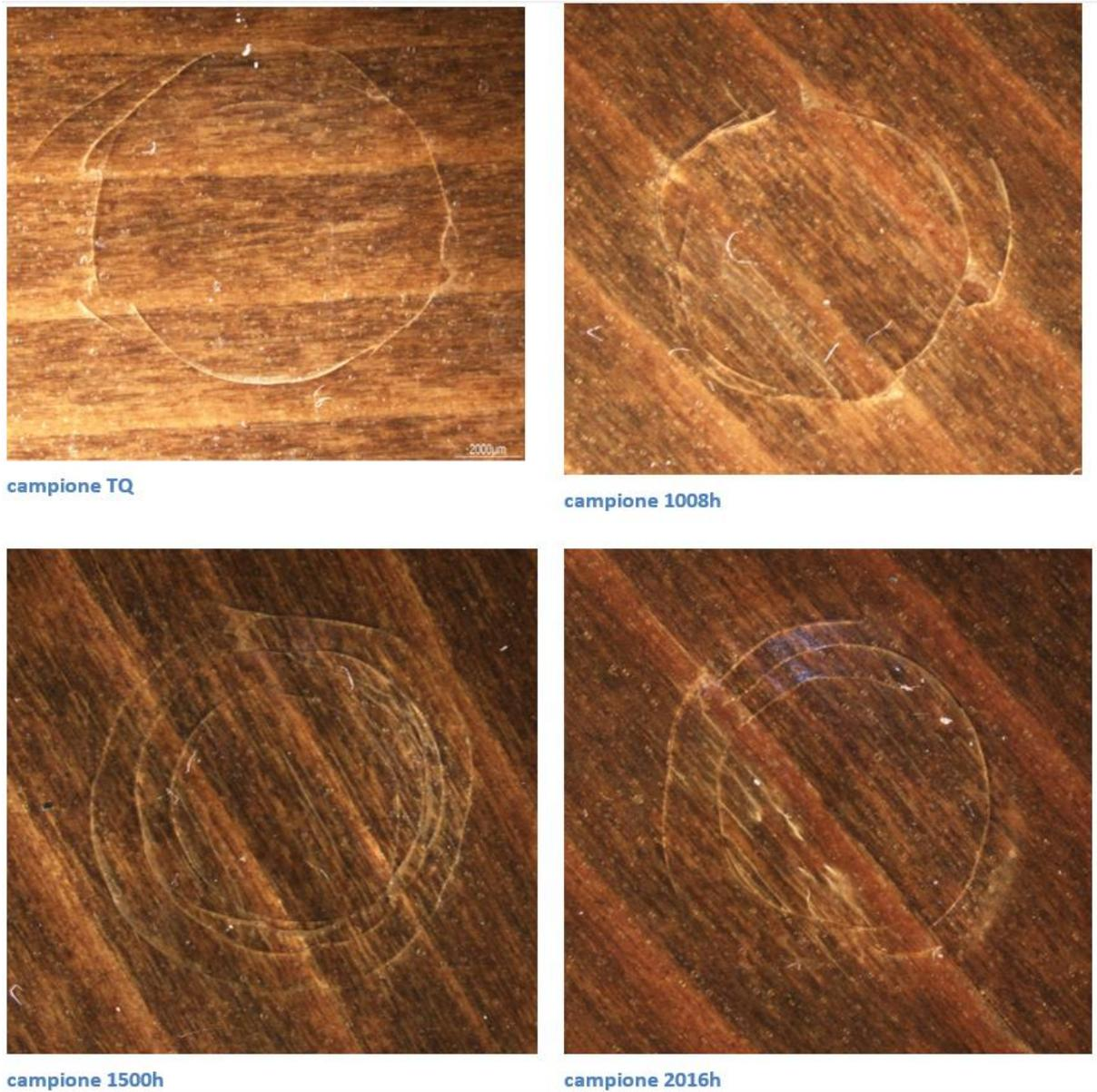
Figura 101 Immagini Impact Test del campione D
