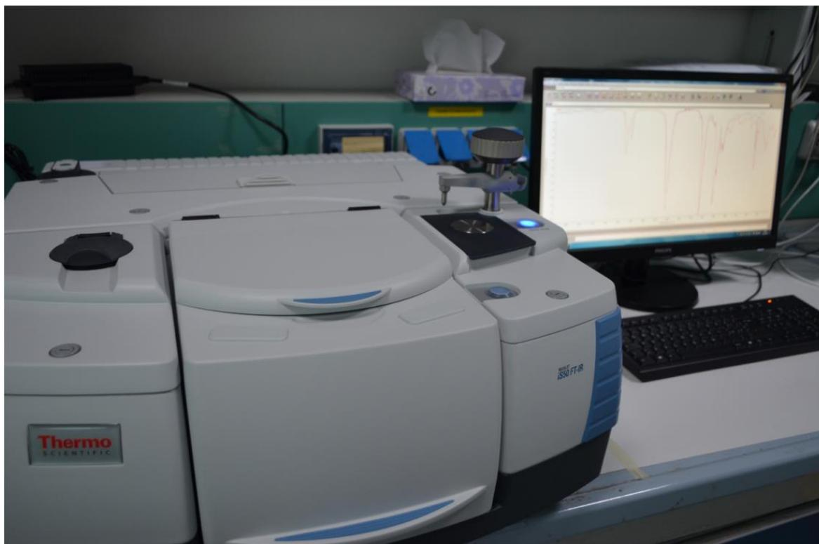
Figura 38 spettrometro Nicolet iS50 FT-IR della Thermo Fisher,
