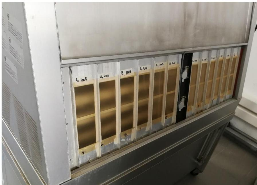
Figura 22 Predisposizione dei campioni di film libero nel QUV tester
