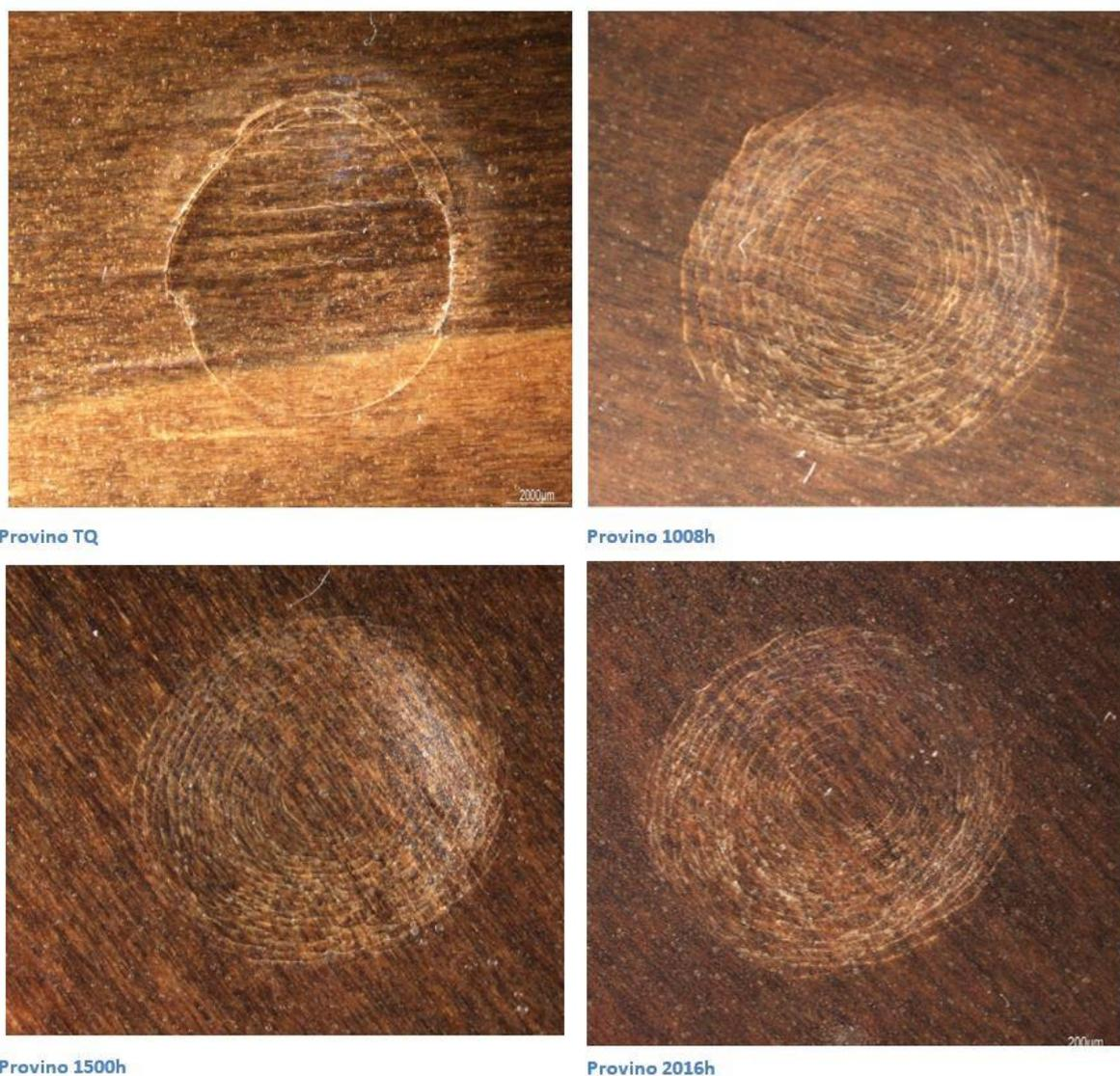
Figura 72 Immagini Impact Test del campione B
