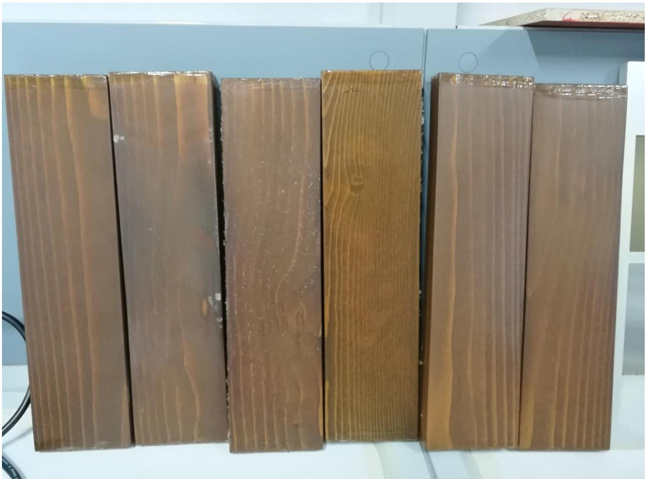
*Figura 46 Campioni in legno dopo 2016h di invecchiamento artificiale, in ordine da A ad F, partendo dal campione A a sinistra.*
