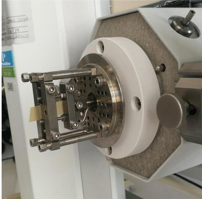
*Figura 28 Configurazione in tensione della DMA*
