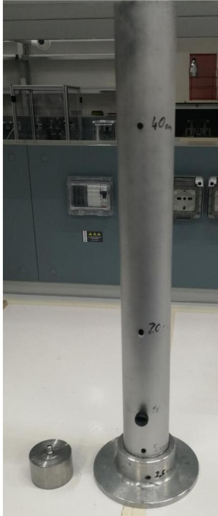
*Figura 41 Tubo per l'impact test e peso da 500 grammi*
