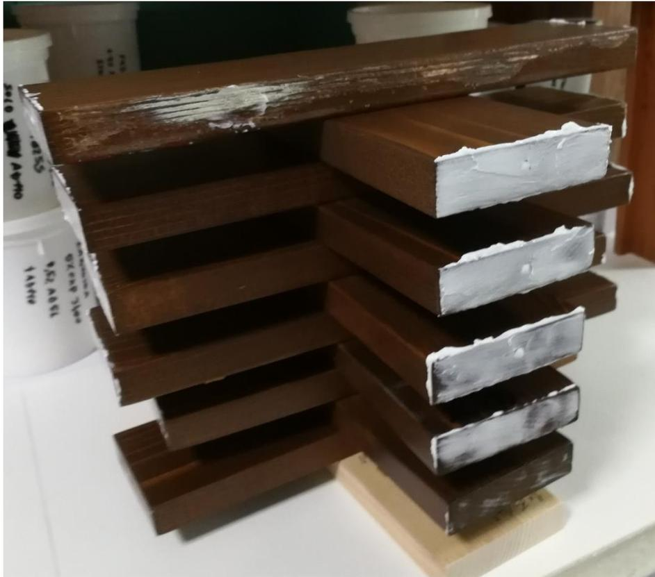
*Figura 19 Provini in legno con applicazione del sigillante acrilico sul legno di testa e sui lati dei campioni.*
