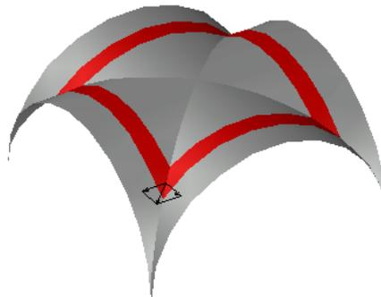
Figura 37 – Schema strutturale volta a crociera
