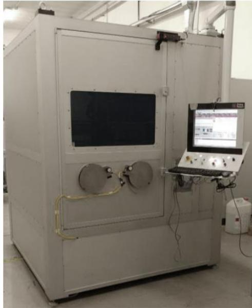
*Figura 23. Prototipo di macchina per Direct Energy Deposition*
