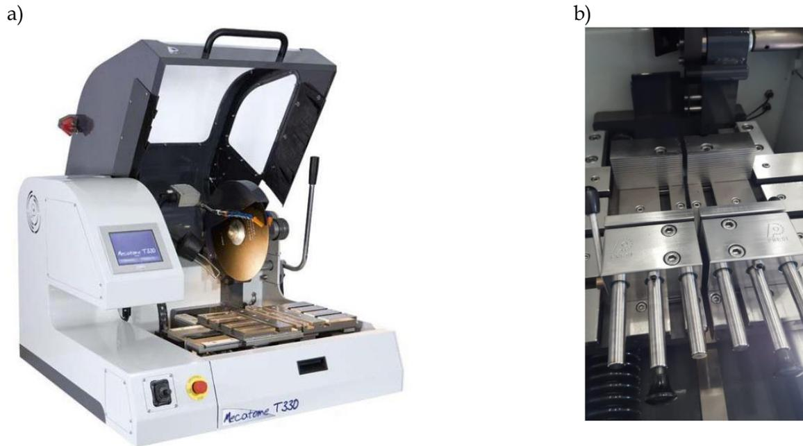
Figura 38. (a) Troncatrice di Presi, (b) dispositivo di bloccaggio.
