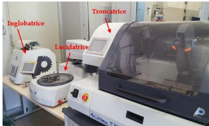
Figura 37. Attrezzature per la preparazione metallografica campioni.
