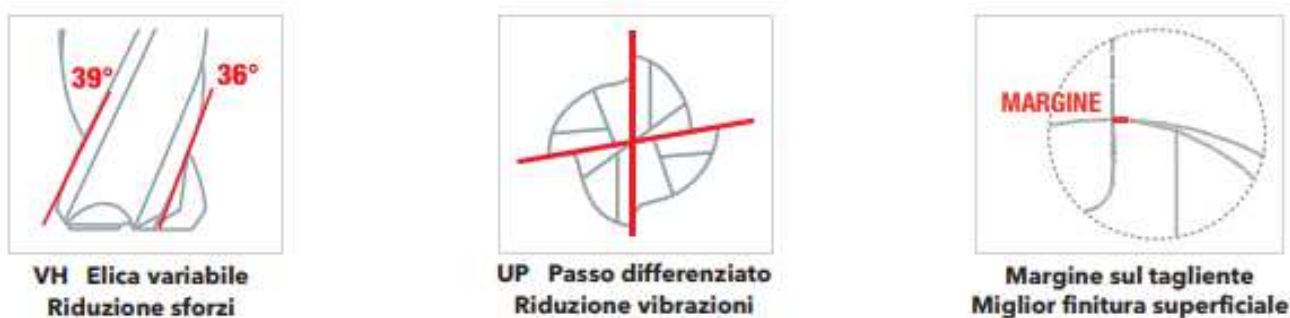
Figura 26: Aspetti migliorativi per la lavorazione delle superleghe [24].
