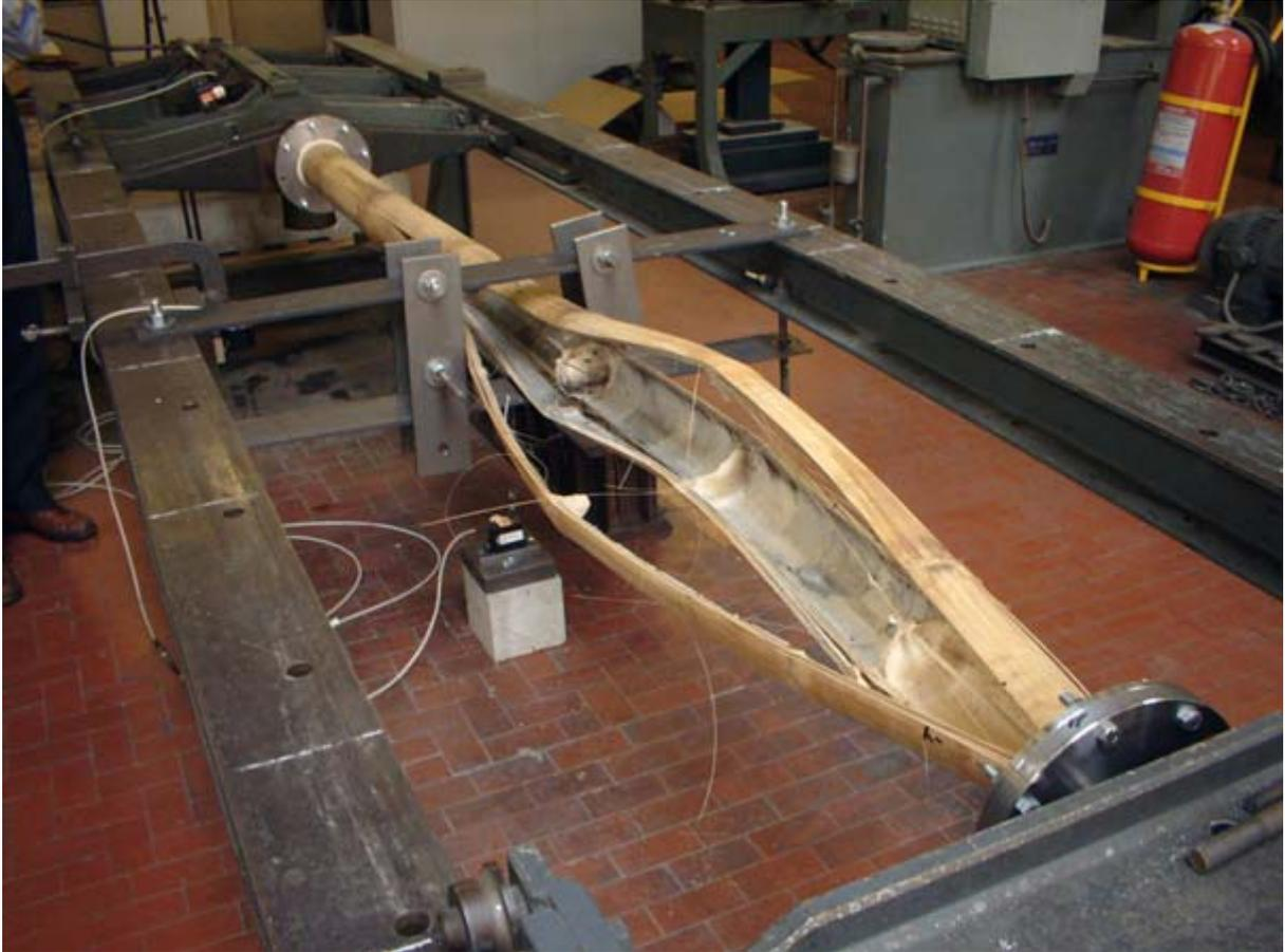
Le dimensioni degli elementi che formano il giunto, e i diametri dei culmi, impongono tuttavia dei limiti alle resistenze massime del sistema, che lo rendono adatto solo per determinati usi, dove i carichi in gioco sono molto bassi come appunto nel caso di padiglioni o coperture leggere per saloni o esposizioni.
