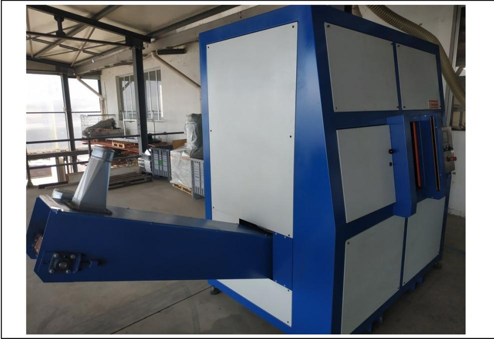
**Figura 58. Macchina per separazione motori elettrici vista laterale**
