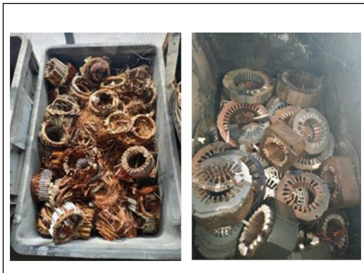
**Figura 26. Separazione materie prime seconde statori**
