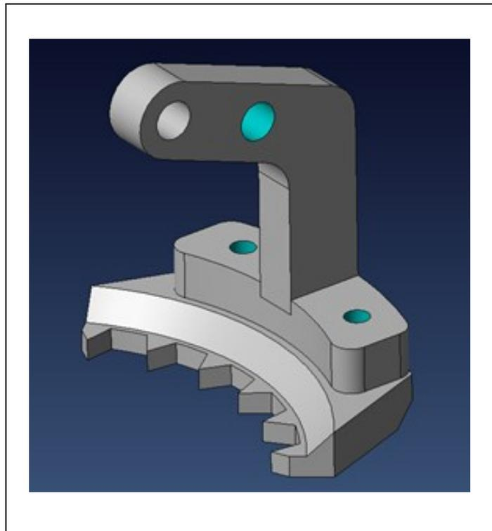
**Figura 40. Dettaglio leva ganascia esterna**
