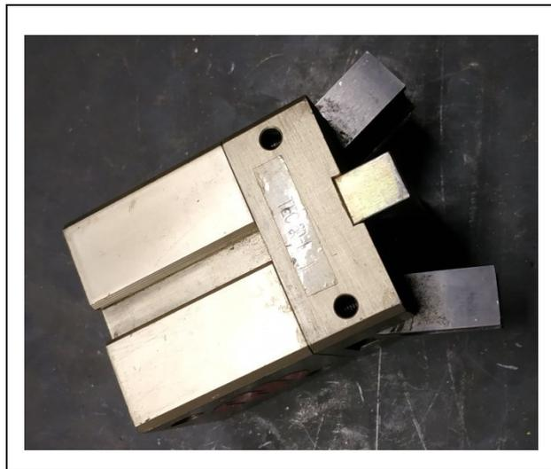
**Figura 23. Pinza pneumatica angolare**
