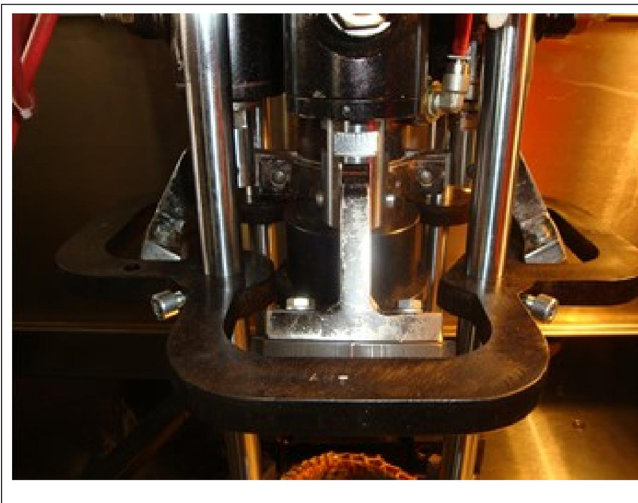
**Figura 50. Vista frontale pinza idraulica setup lavatrici**
