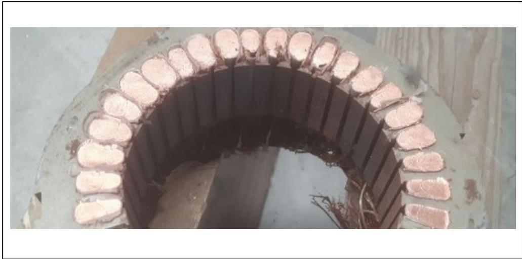
**Figura 8. taglio dei trefoli di rame tramite disco abrasivo**
