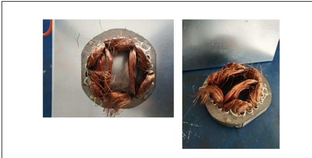
**Figura 35. Statore lavatrice con rame collassato verso l'interno.**
