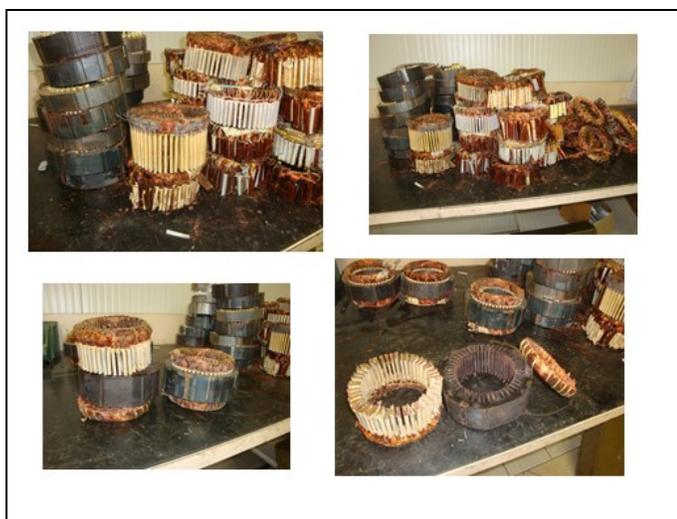
**Figura 54. Statori processati con pinza idraulica**
