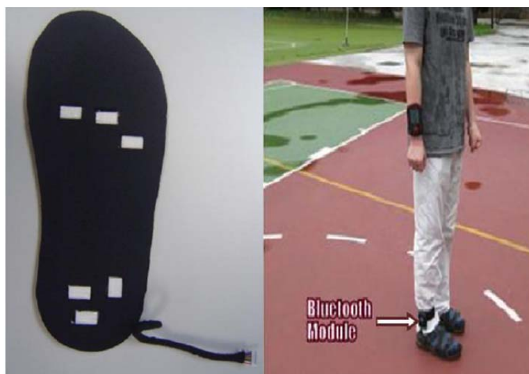
Figura 2.3.3 Sistema di misura e analisi di pressioni plantari di Shu et al.
