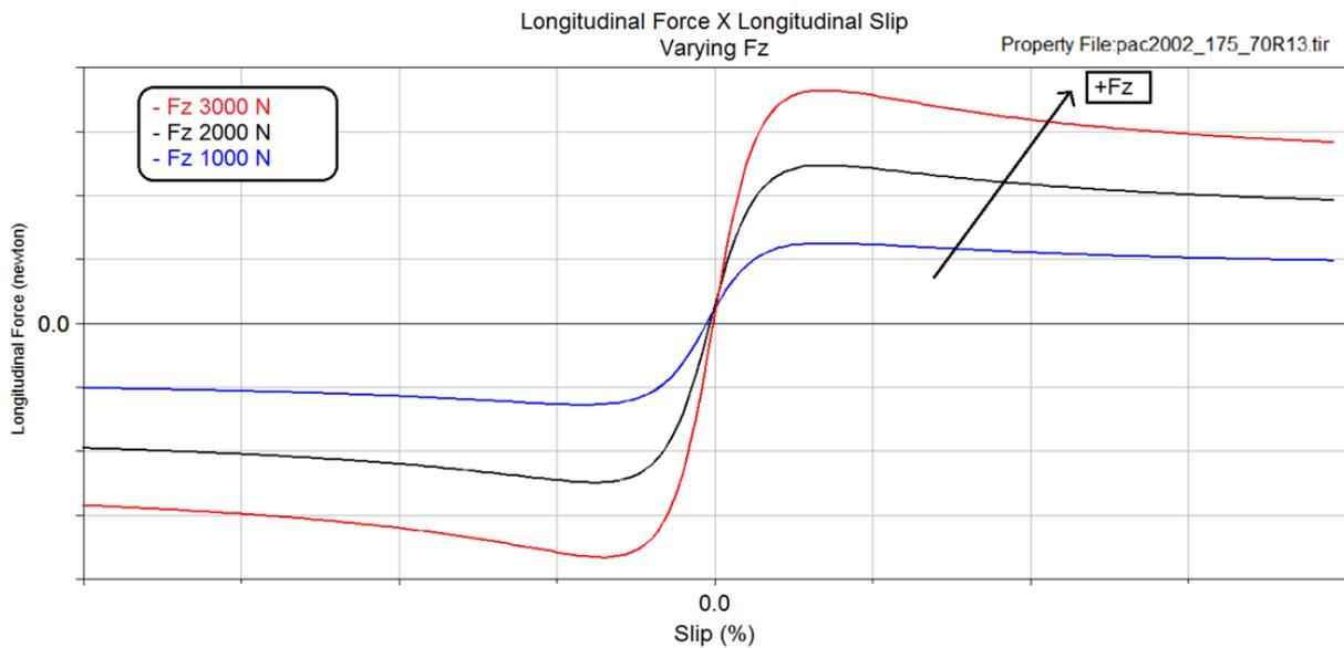
Figure 3.3 - Longitudinal force vs Longitudinal slip
