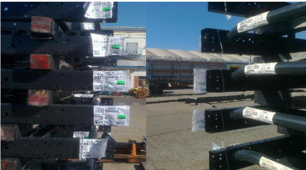
**Figura 5.2;** tags installati sui telai del fornitore [fonte: CNH Industrial]
