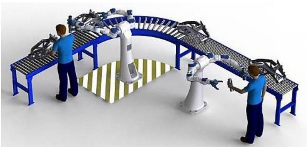
**Figura 2.3** Cobots applicati lungo una linea di produzione. [<https://www.sirris.be/blog/will-your-next-employee-be-cobot>]
