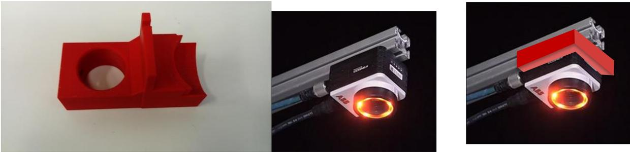
Figura 3.8 Supporto alla telecamera di lettura del volante. [Fonte: Valladolid AM Report, 2018]
