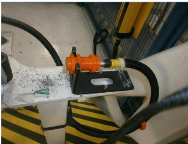
**Figura 3.5** Metal Detector realizzato in manifattura additiva [Fonte: Valladolid AM Report, 2018]
