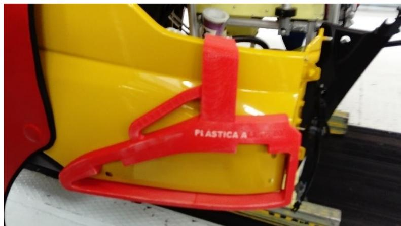
Figura 3.7 Tool utile al posizionamento del parafango [Fonte: Valladolid AM Report, 2018]
