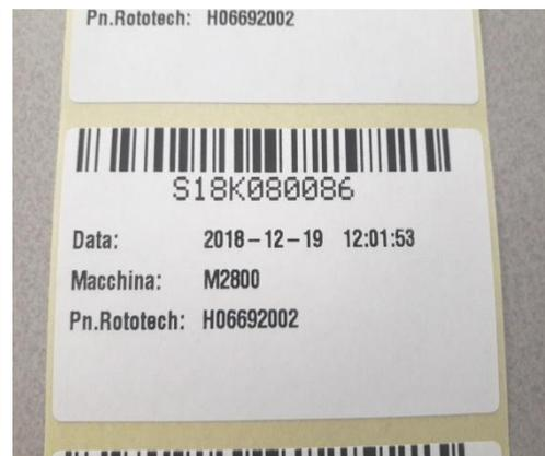
Figura 45: Etichette identificative per ogni singolo pezzo stampato dotate di barcode per la lettura e del codice del prodotto.
