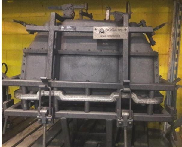
Figura 12: Esempio di stampi che possono essere montati sui bracci delle macchine tradizionali. Un tipo di stampo può essere assegnato ad una sola macchina principale e ad una macchina di riserva, in base al tipo di codice prodotto e alla conformazione dello stampo stesso.
