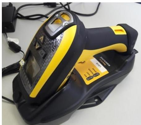
Figura 42: Dispositivo di lettura dei barcode e data matrix presenti sulle etichette degli stampi e dei singoli prodotti.
