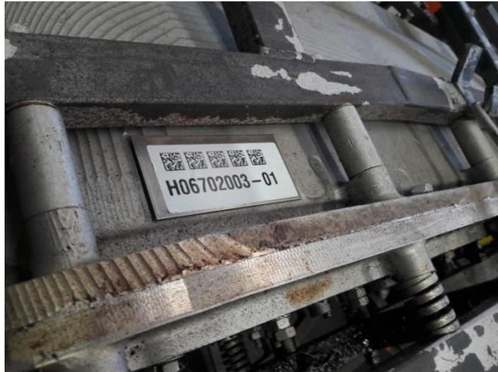
Figura 43: Etichetta identificativa per ogni stampo dotata di cinque data matrix per la lettura dello stampo tramite lettore barcode, del codice del prodotto (H06702003) e del numero dello stampo (- 01).
