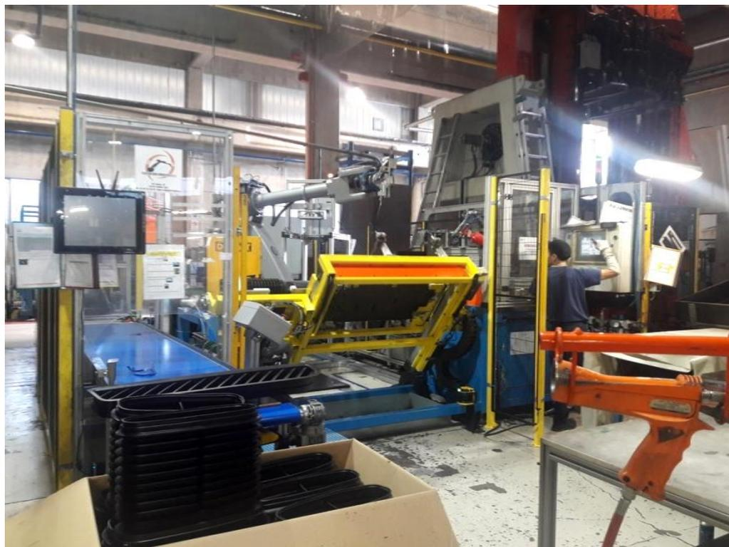
Figura 49: Robot 4 durante l'assemblaggio dei codici H06692002 e H06702003 per ottenere lo snorkel S06683003. L'operatore ha la possibilità di visualizzare i dati della macchina e di consultare a video la programmazione della produzione per essere consapevole dell'obiettivo da raggiungere a fine turno e per valutare l'avanzamento della produzione.
