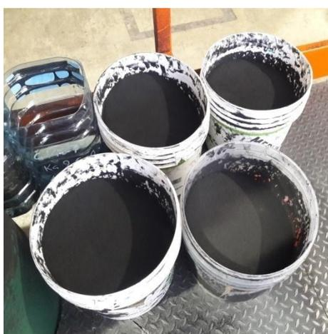
Figura 10: Secchi di polvere di materiale plastico già pesata a bordo macchina pronta da inserire nello stampo.
