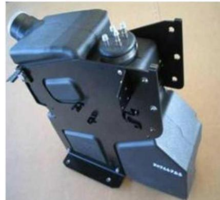
Figura 22: Serbatoio urea per veicolo industriale. [2]
