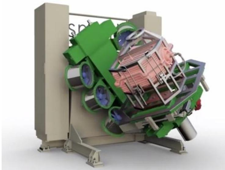
Figura 18: Illustrazione della macchina di stampaggio rotazionale automatica Smart presente in Rototech. [22]
