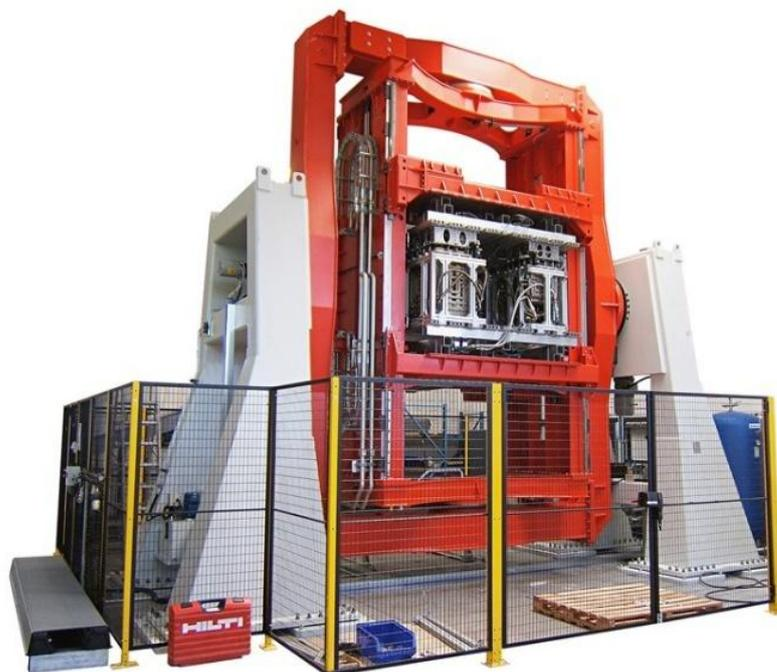
Figura 17: Illustrazione della macchina di stampaggio rotazionale automatica Leonardo presente in Rototech. [22]
