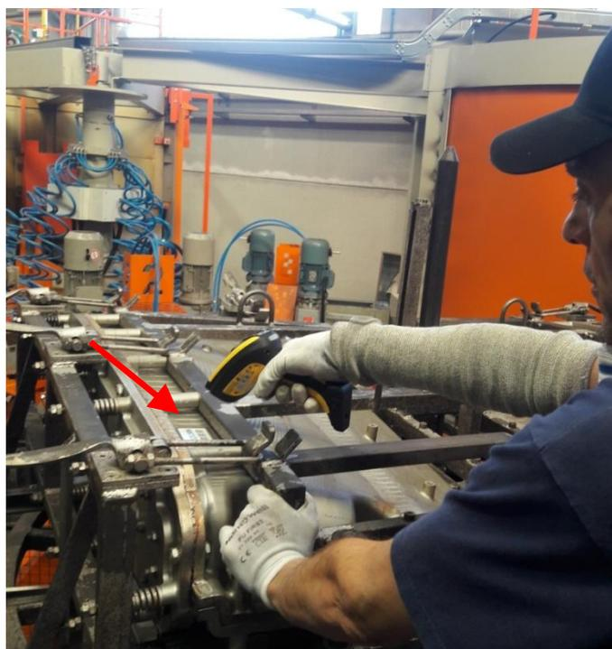
Figura 55: Viene mostrato il passaggio della lettura dello stampo da parte dell'operatore addetto allo stampaggio. Viene da qui inviato al sistema MES il segnale di estrazione del prodotto e vengono inseriti nel database di frontiera i dati riferiti alla macchina, al codice prodotto, l'ora, il codice dello stampo, il braccio macchina, e i parametri macchina (temperature e tempi ciclo).
