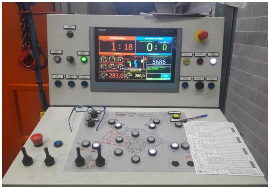
Figura 48: Display a bordo macchina che mostra i parametri caratteristici e lo scorrere del tempo ciclo di cottura e raffreddamento del braccio all'interno del forno e della camera di raffreddamento. I comandi intorno e al di sotto del display servono per manovrare i bracci e per segnalare anomalie.
