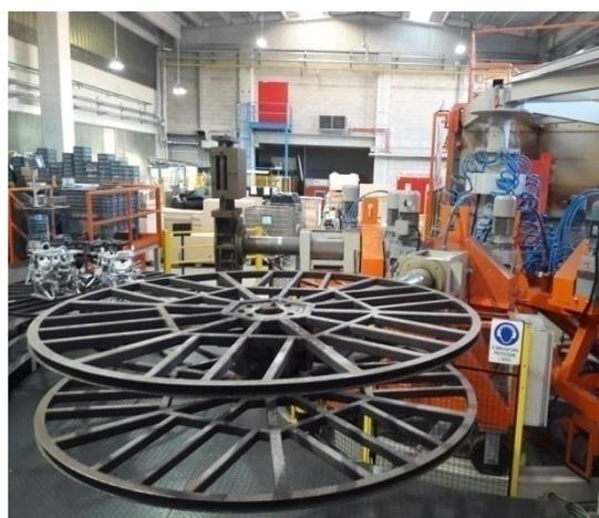
Figura 11: Ruote installate sui bracci delle macchine che consentono di montare più stampi e di produrre contemporaneamente più pezzi.
