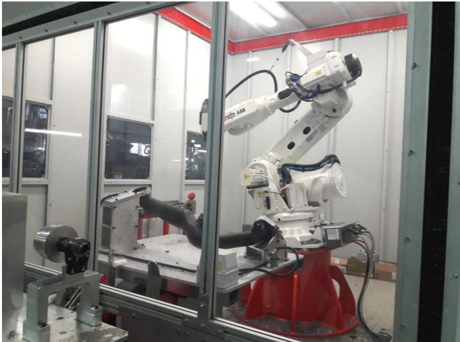
Figura 51: Roboticom durante la lavorazione di un tubo nylon. Il robot compie le operazioni di tastatura (per il riconoscimento del pezzo e l'avvio del programma adeguato), foratura, alesatura e piantaggio anelli alle estremità del prodotto. Mentre il braccio robot compie le operazioni all'interno dell'isola, l'operatore all'esterno preparerà il posaggio successivo da lavorare.
