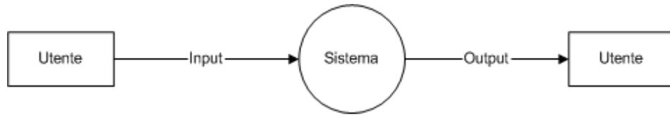
Figura 6: Semplice esempio di un modello a flusso di dati in cui le informazioni provenienti da un utente esterno vengono inviate (Input) al Sistema che le elabora e le manda (Output) ad un altro utente.
