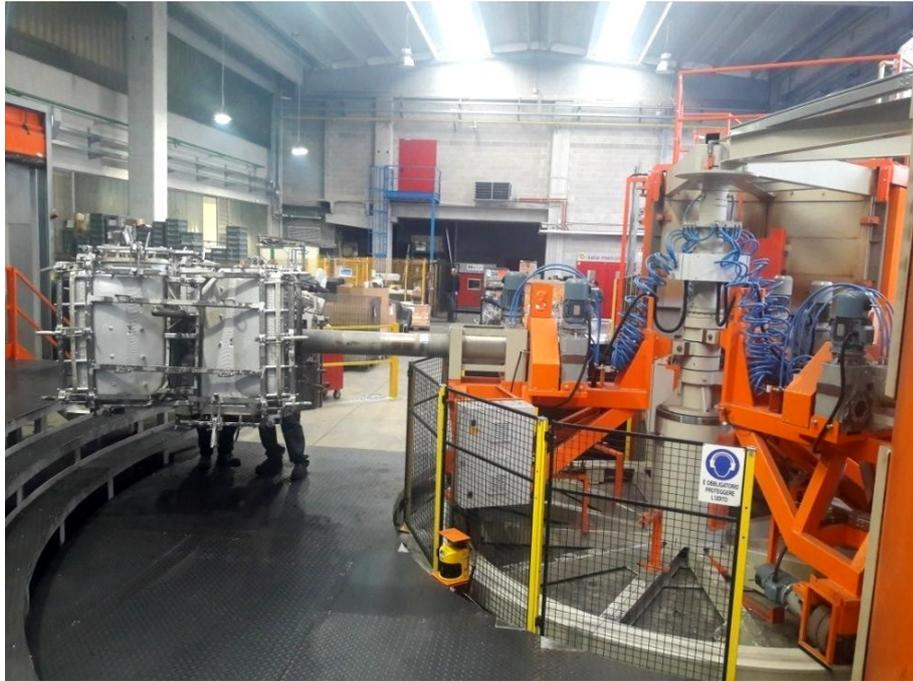
Figura 47: Macchina M2800 con vista dello stampo montato su un braccio da due operatori, pronto per essere mandato in forno.
