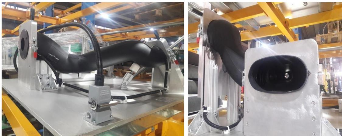
Figura 50: Esempi di posaggi e di tubi nylon che vengono lavorati dal Roboticom. Ogni posaggio è costruito "su misura" ed è adatto per la finitura di un solo codice.
