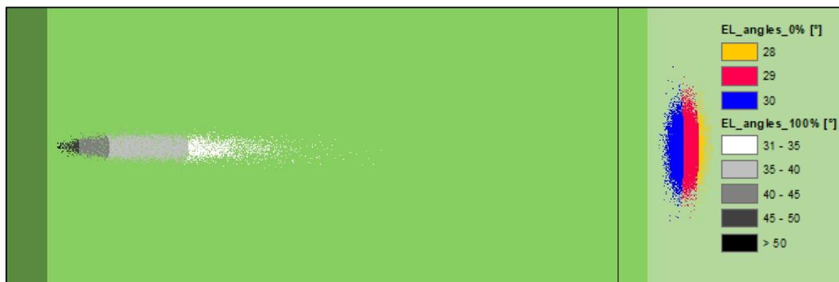
Figura 2.9: distribuzione spaziale degli angoli di energy line per una distribuzione di densità di vegetazione pari a 0% (assenza di vegetazione) e per una distribuzione pari a 100% (1 albero per ogni cella del DTM).
