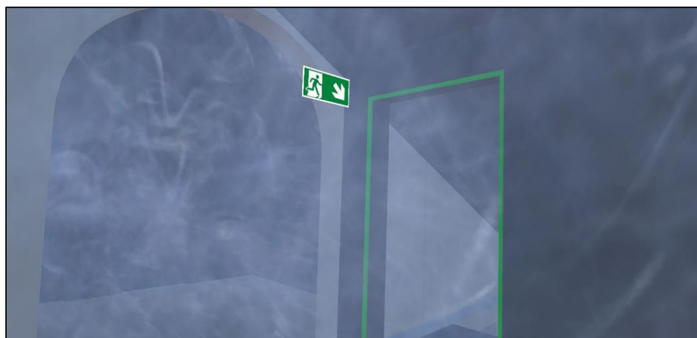
Figura 120. Test della segnaletica luminescente posta perimetralmente alle porte di uscita.
