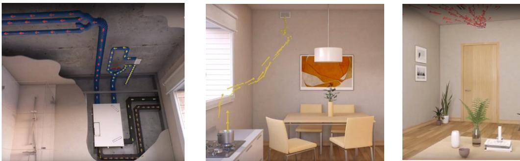
Figura 139-Sistema di ventilazione residenziale con recupero termico, centralizzato per singolo appartamento. [www.pluggit.com](http://www.pluggit.com)
